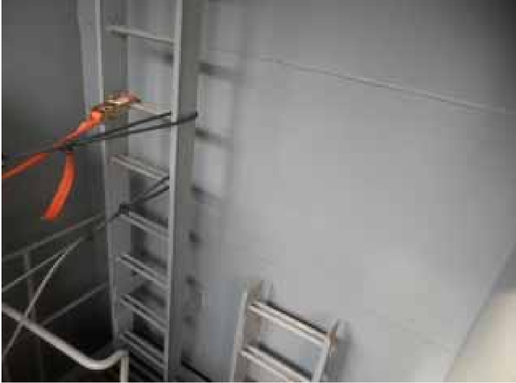
圖5.34 | 應避免如圖所示，將綁紮物綁縛於包括梯子在内的船舶結構上。
