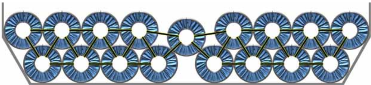
圖5.8 | 兩層鋼卷的積載，其中第二層鋼卷排布至舷側外板。
