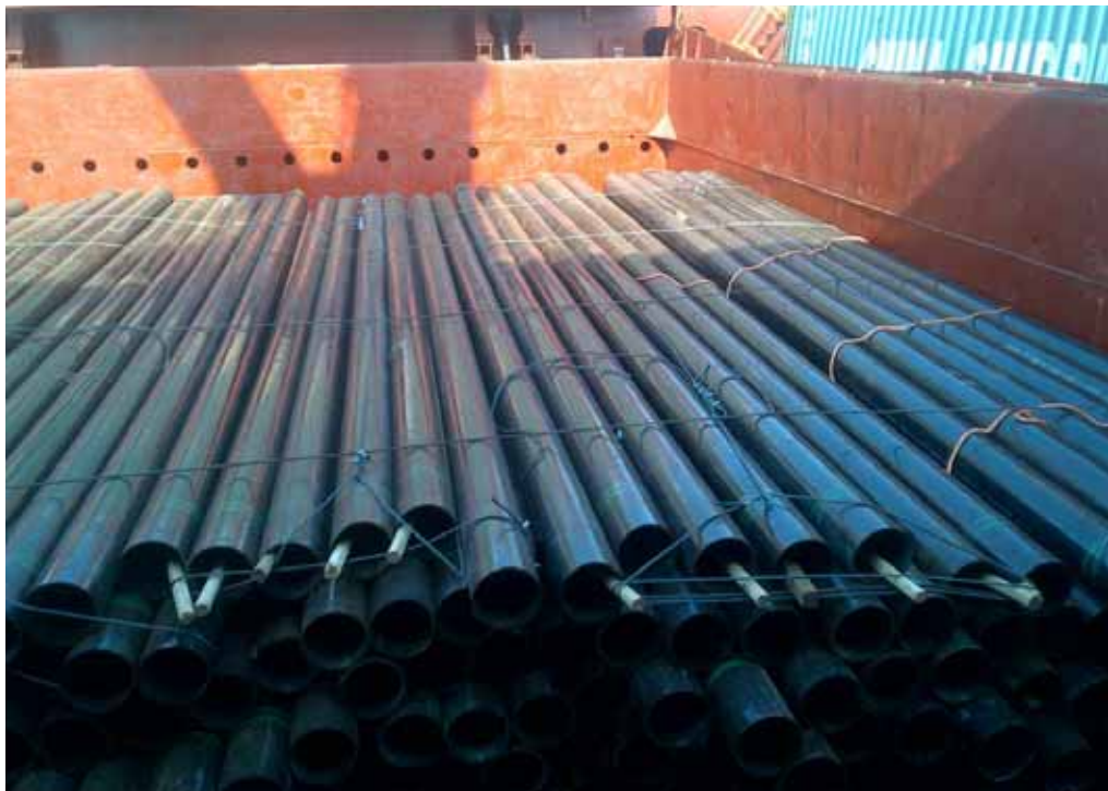
圖5.35 | 經系固/綁紮的大直徑鋼管。請注意，前景中插入鋼管內的墊木是用來綁紮和系固積載於頂層的鋼管的。
