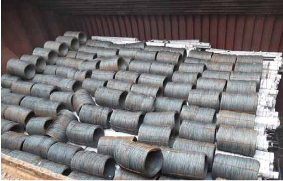
圖4.2 | 堆垛於包裝鋼管上方的單層和雙層鋼盤條。
