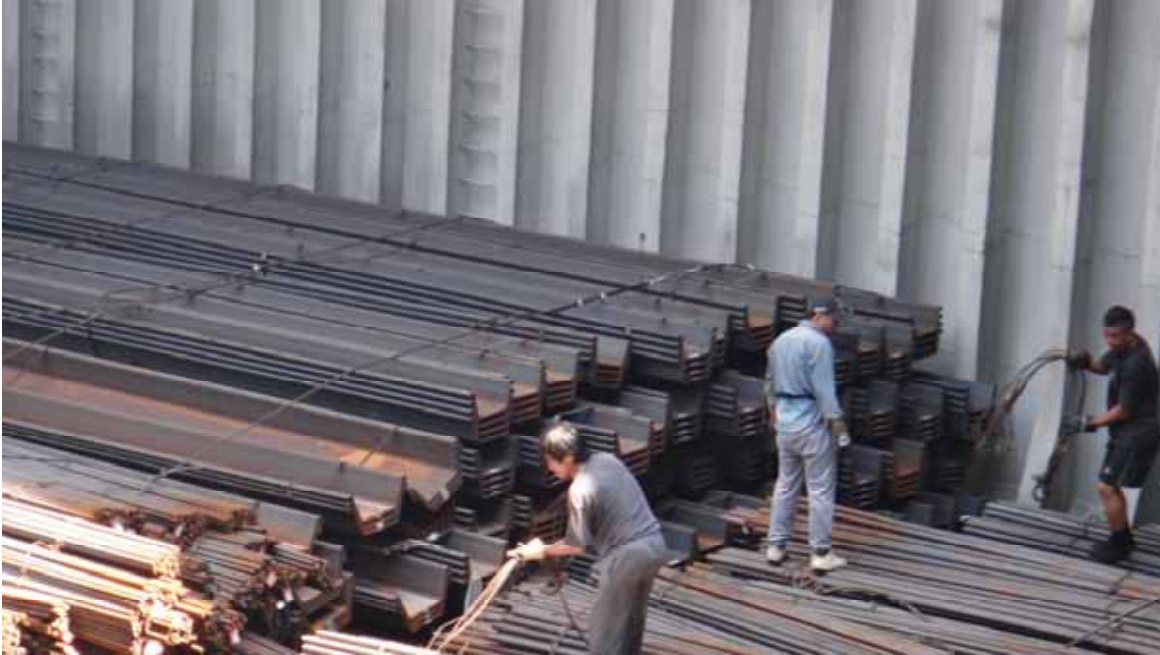
圖5.30 | 裝卸工人正準備對前景中的鋼棒及鋼板樁進行綁紮。背景中的槽鋼已使用鋼絲繩、繩夾和螺旋扣綁紮。
