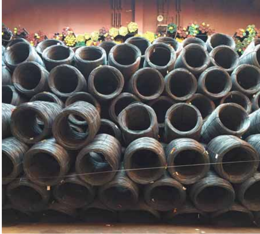
圖1.16 | 由於積載和綁紮不當，導致盤條堆碼坍塌。
