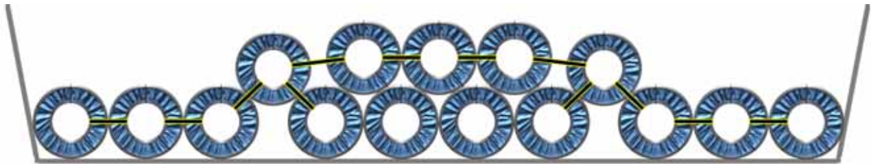
圖5.10 | 局部兩層鋼卷的積載，其中兩個鎖定鋼卷對稱放置，第二層的部分鋼卷以“覆蓋”方式綁紮於第一層的兩個中心鋼卷的上方。
