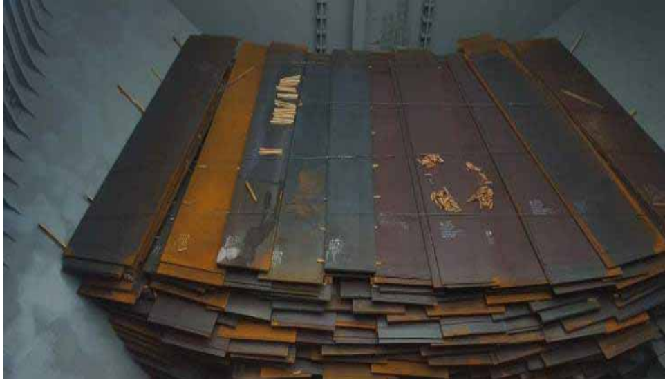
圖5.24 | 細長鋼板在艙部貨艙內積載，並以鋼絲綁紮。請注意，貨物在斜邊艙內的裝載方式為：通過在斜邊艙內層疊積載，充分利用待裝貨物的體積。
