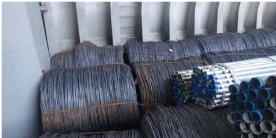
圖1.2 | 積載的鋼絲和小直徑鋼管。請注意，後排最左的鋼卷由於壓靠在舷側肋骨上而發生了變形。對於較高的鋼卷貨堆，這一點尤其值得注意，因為低層鋼卷會有被壓向船舶外部艙壁的情況。
