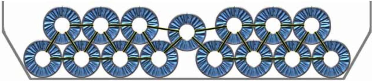
圖5.9 | 兩層鋼卷的積載，其中第二層鋼卷按兩個半金字塔形裝載。請注意，與圖5.8相比，第二層的外側鋼卷有額外綁紮/系固，以防這些鋼卷在運輸途中向舷側外板移動。
