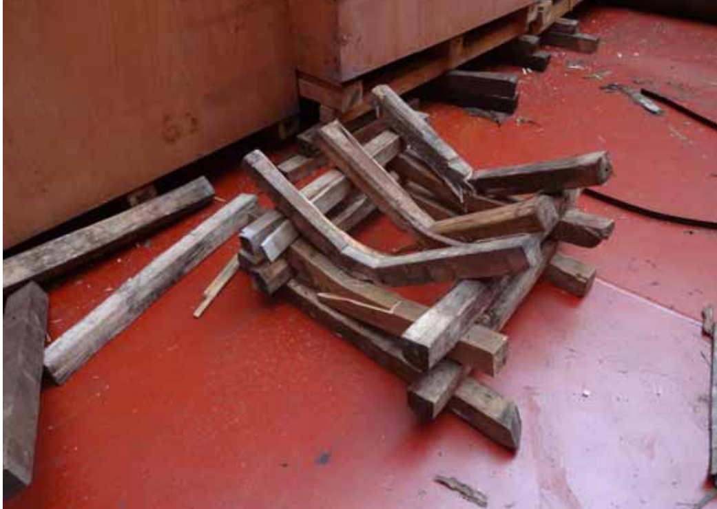
圖4.10 | 排布不當的墊艙物在貨物重壓下坍塌。
