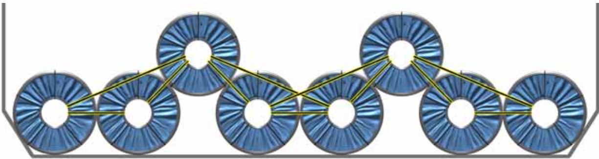
圖5.17 | 單層重或超重鋼卷的積載，其中兩個鎖定鋼卷對稱放置。請注意，與圖5.7相比，超重鋼卷中的“關鍵”或“鎖定”鋼卷有額外系固/綁紮。
