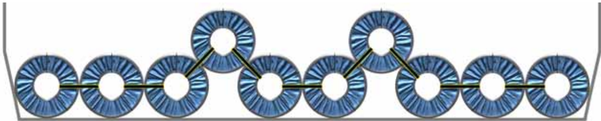
圖5.7 | 單層鋼卷的積載，其中有兩個對稱放置的鎖定鋼卷。
