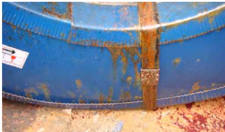
圖1.3 | 因航程中貨物汗濕而導致鋼卷包裝受損。
