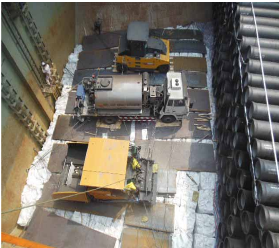
圖3.13 | 將鋼板置於袋裝貨物上方，以支撐車輛和機器，相鄰的大直徑鋼管呈艙艙向裝載。
