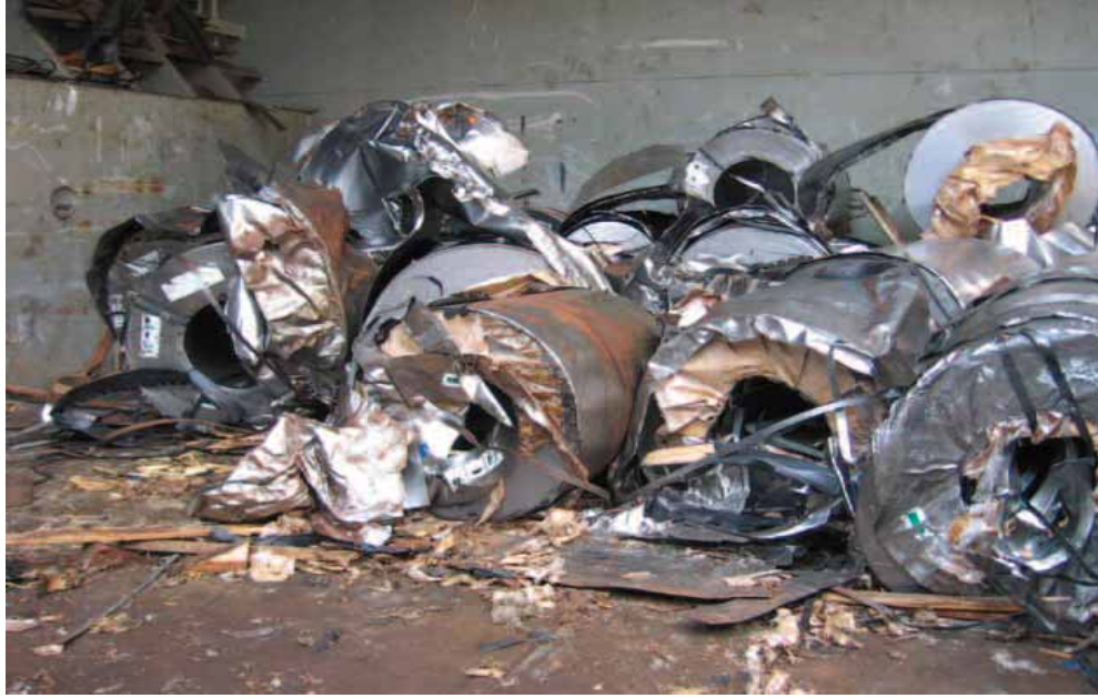
圖1.10 | 因貨物發生位移而受損的鋼卷。
