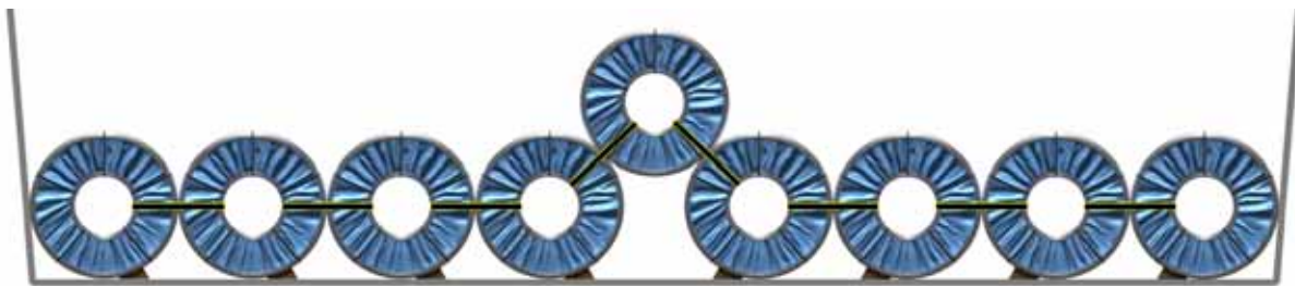
圖5.2 | 單層鋼卷的積載，以位於中心的架高鋼卷為“關鍵”或“鎖定”鋼卷。
