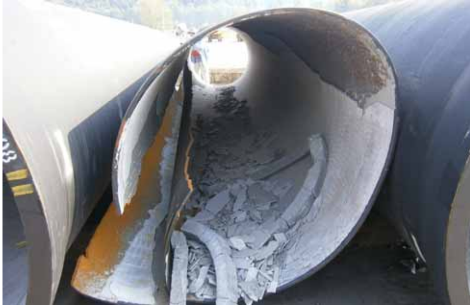
圖1.8 | 受船上其他貨物擠壓而壓壞的鑄鐵管。
