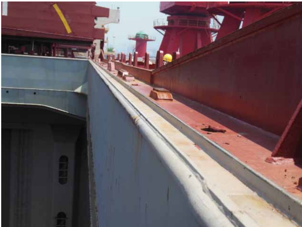
圖2.2 | 表明處於良好狀況的排水槽、壓條和緩衝墊。
