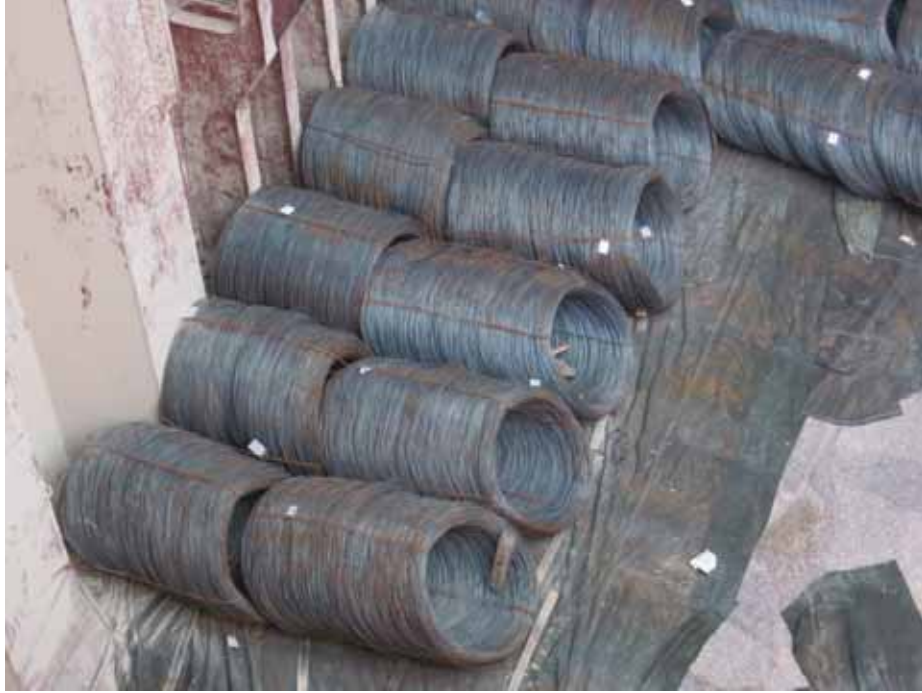
圖3.5 | 卸船中的鋼盤條。請注意，貨艙底部的帆布上方放有墊艙木料，儘管這並不是通常的墊艙做法。
