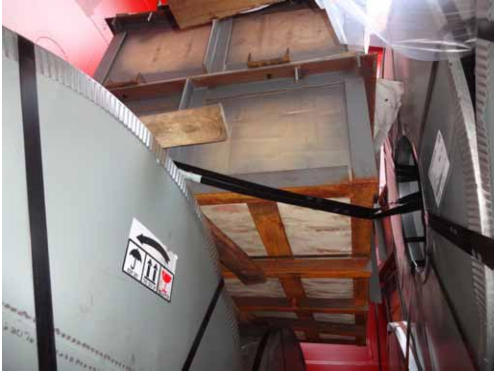
圖5.6 | 請注意，木箱不應被擱在鋼卷的系固鋼帶上。
