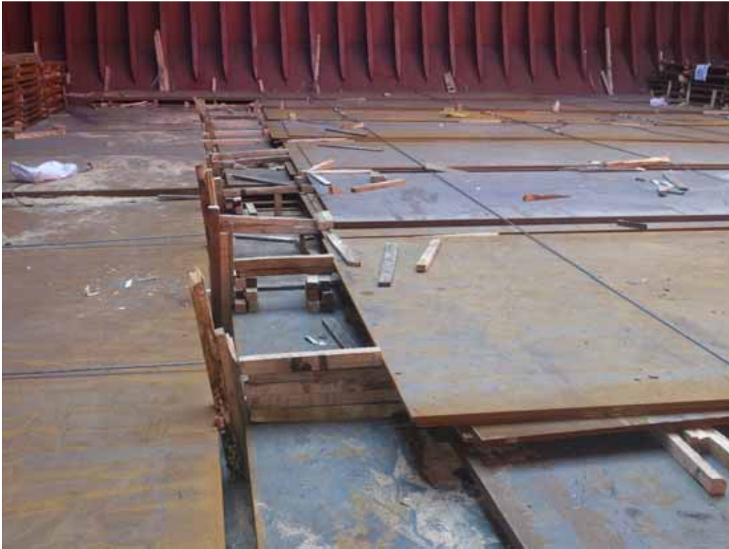
圖5.27 | 船舶啟航前，鋼板之間的空隙應當適當墊塞。
