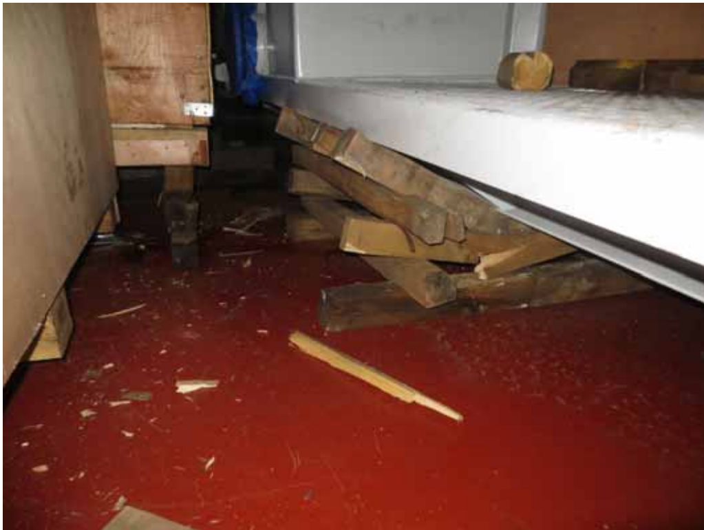
圖4.7 | 墊艙物被壓壞，導致堆碼貨物受損。
