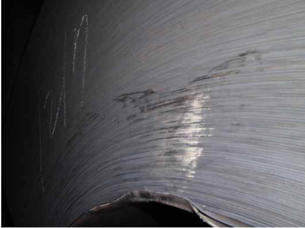
圖1.4 | 鋼卷在船舶貨艙內進行積載時，被叉車的圓柱形貨卷升降叉損壞。
