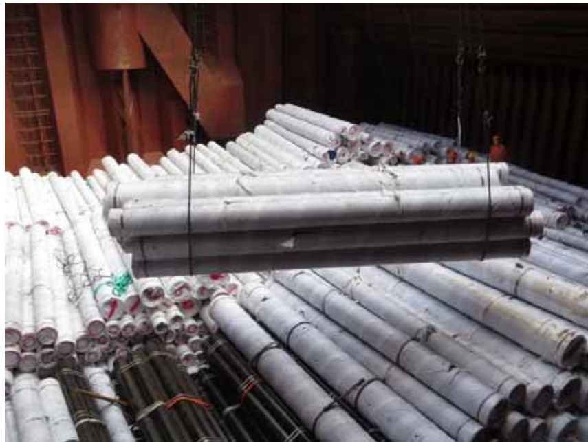
圖3.4 | 包裝好的成捆大直徑鋼管正在被裝入貨艙。
