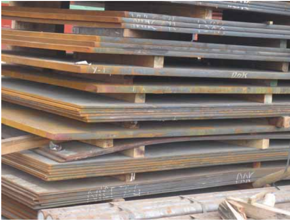
圖1.9 | 由於襯墊物未垂直排列而變形的鋼板。
