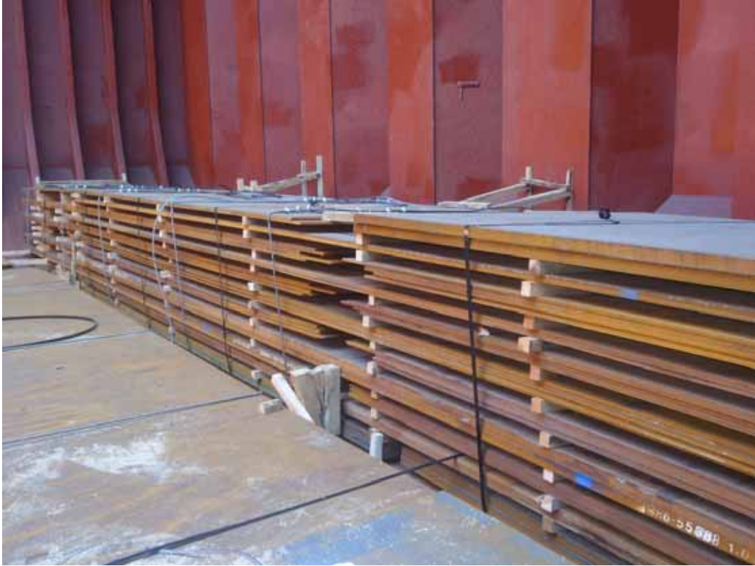
圖5.28 | 靠著艙壁橫向堆碼的鋼板經適當襯墊，並使用鋼質綁紮帶綁紮/系固。
