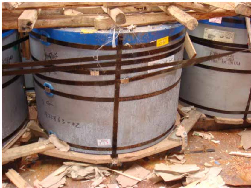
圖5.21 | 使用貨盤的鋼卷以“卷眼朝上”的方式積載。
