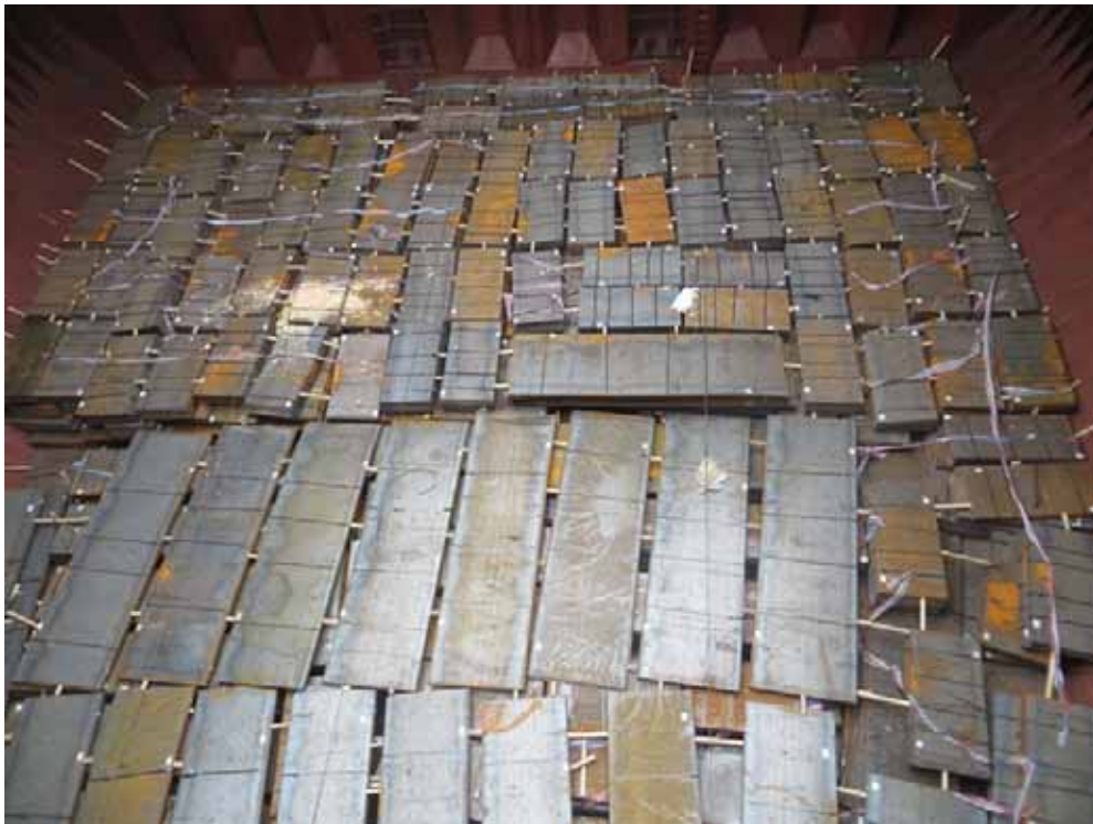
圖5.25 | 貨艙內積載和綁紮的成捆鋼板。請注意位於照片前景中的長鋼板的墊木，墊木之間有著適當的水準間距，以防鋼板在運輸途中發生變形。
