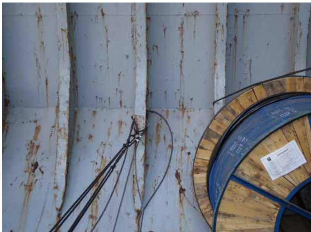
圖5.33 | 應避免如圖所示，將綁紮物綁縛于舷邊肋骨上。
