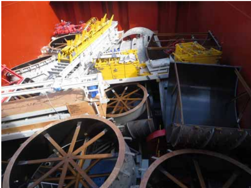
圖1.17 | 積載不當的各類鋼質貨物，可導致船舶卸貨延滯。
