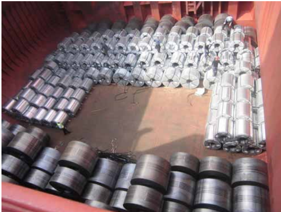
圖3.6 | 積載於貨艙內的冷軋鋼卷使用1英寸（2.5釐米）扁平鋼帶綁紮。
