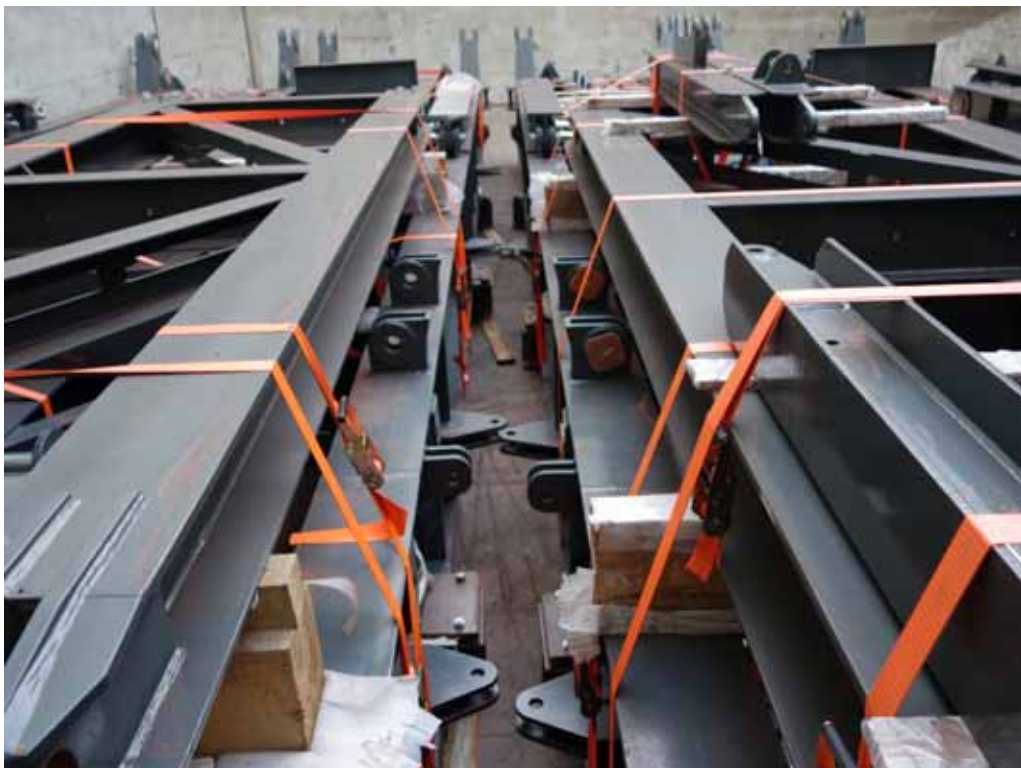
圖5.32 | 用於“工”型梁的尼龍捆紮帶和棘輪緊線器
