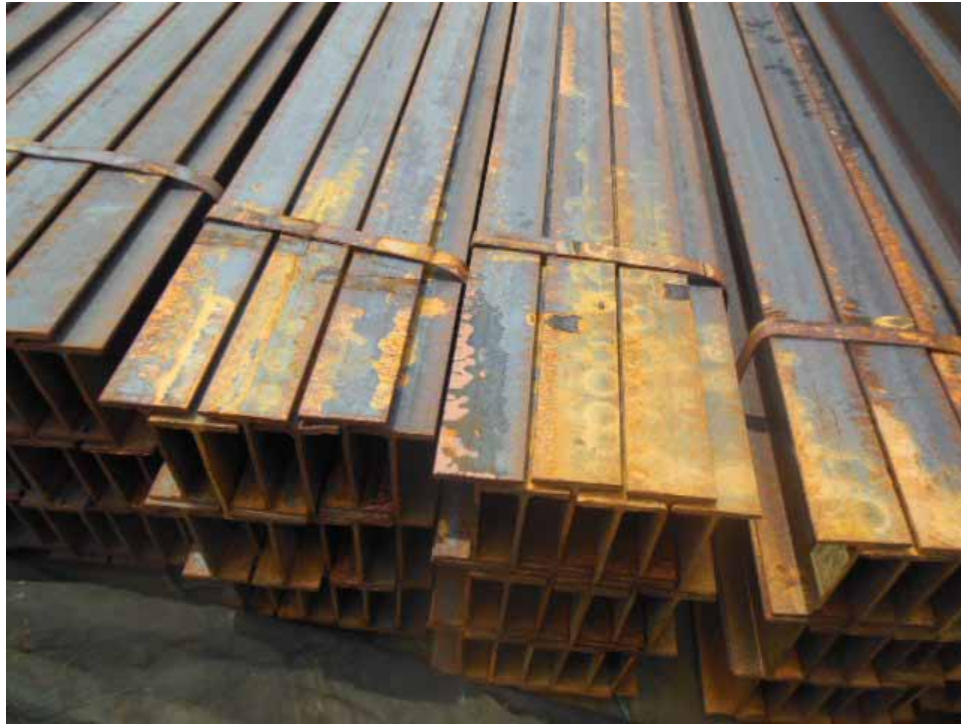
圖3.1 | “工”型鋼樑呈凹凸排列，並使用鋼帶系固。
