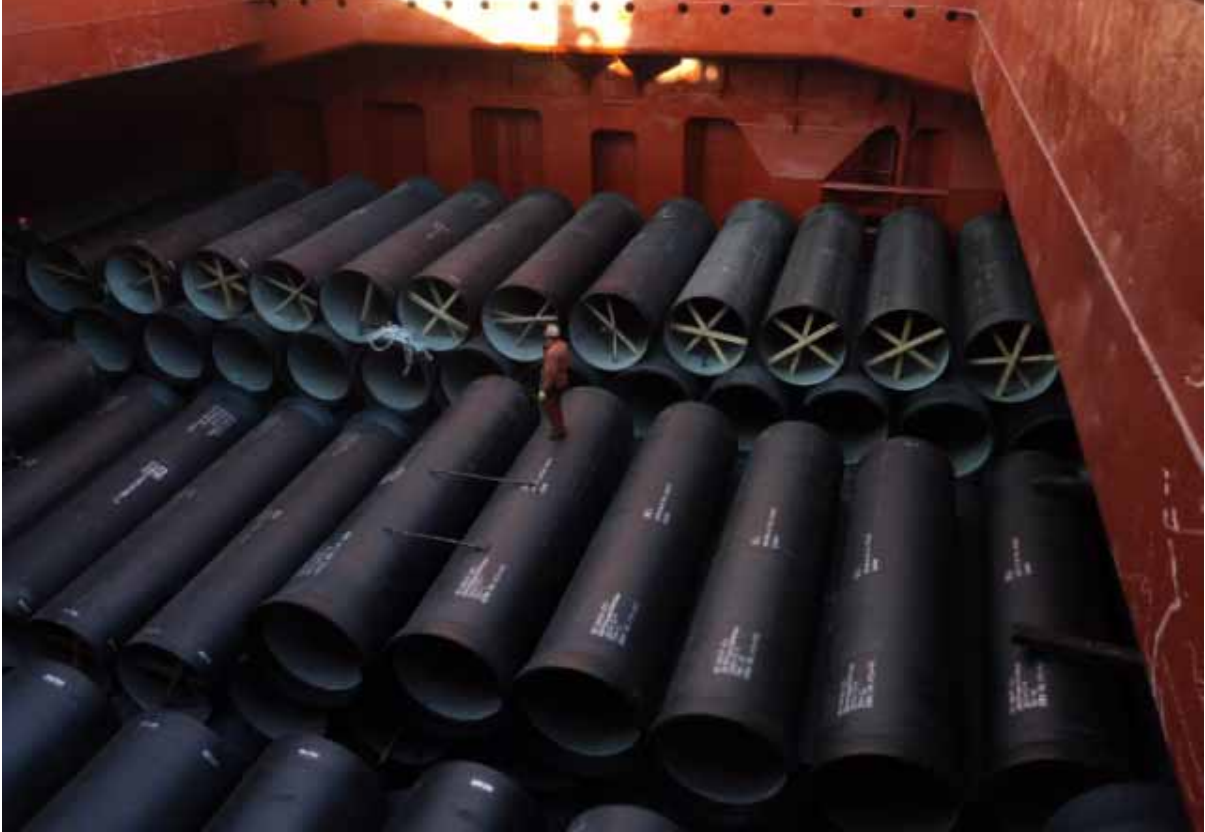
圖3.3 | 帶型鍛管端的大直徑鋼管呈艙艙向積載。請注意鋼管的積載方式為：各層反向放置，以確保相鄰兩層的型鍛管端不疊放。
