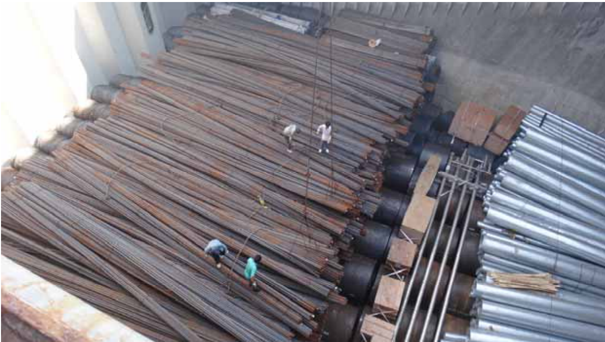
圖3.2 | 裝卸工人正在積載、系固和綁紮鋼質貨物組合。
