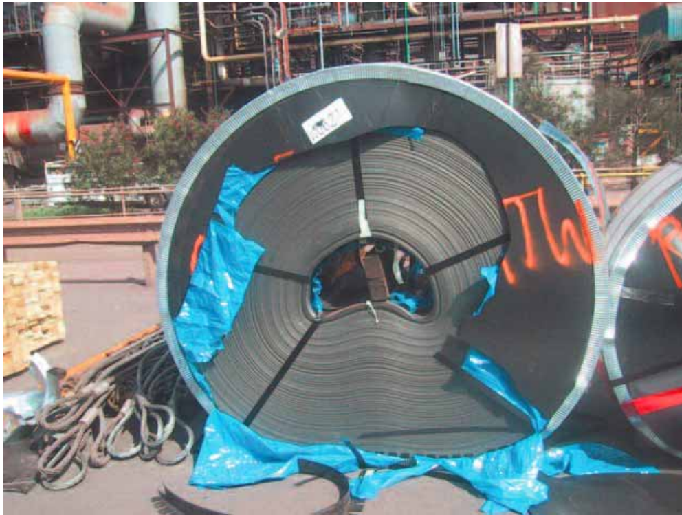
圖1.11 | 因頂層裝載重量過大而變形的冷軋鋼卷。
