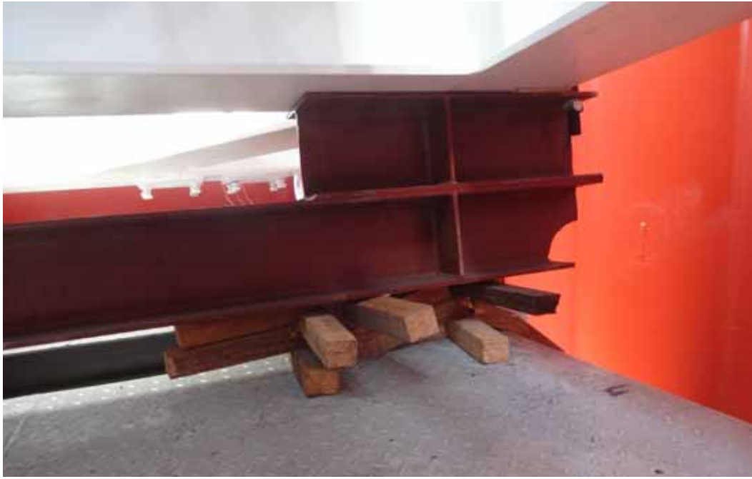
圖4.8 | 由於排布不當，造成墊艙物被壓壞。
