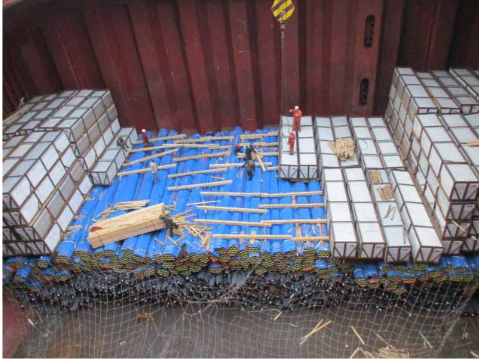
圖3.9 | 貨艙內混裝的鋼筋、小直徑鋼卷和其他鋼製品。
