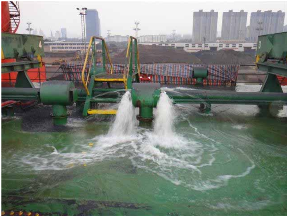
圖2.8 | 壓載艙水壓試驗。
