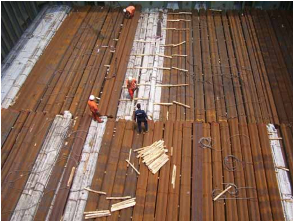
圖3.12 | 角鋼和鋼管在貨艙內呈艏艉向積載。
