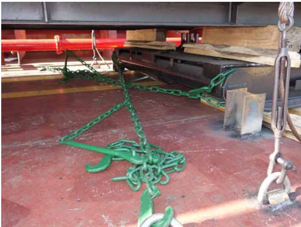
圖5.31 | 用於系固鋼質貨物的鋼鏈和止動扣。
