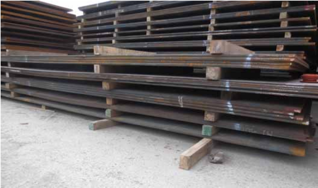
圖4.3 | 岸上等待裝船的鋼板。請注意，襯墊物已適當地垂直排列，以免堆碼鋼板發生變形。對於在船上垂直堆碼的單件和捆裝鋼板，此積載法同樣適用。
