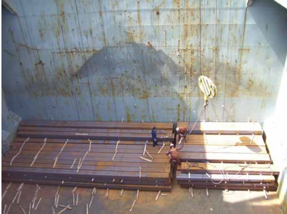
圖3.11 | 成捆槽鋼在貨艙內呈艏艉向積載。
