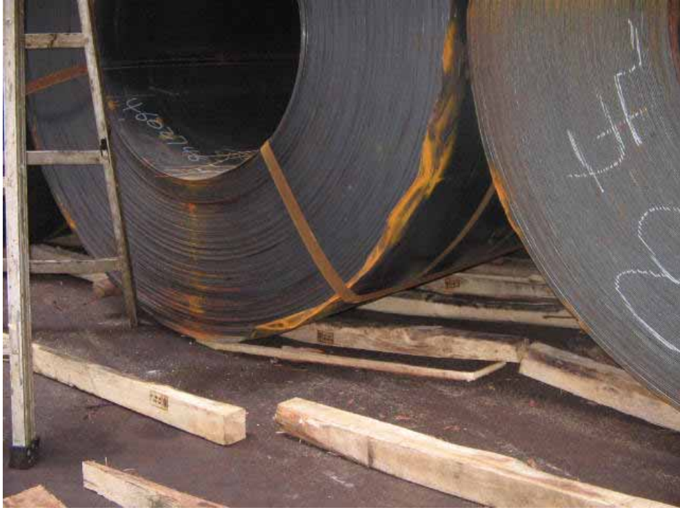
圖4.12 | 墊艙木料被鋼卷的重量壓彎和壓碎。
