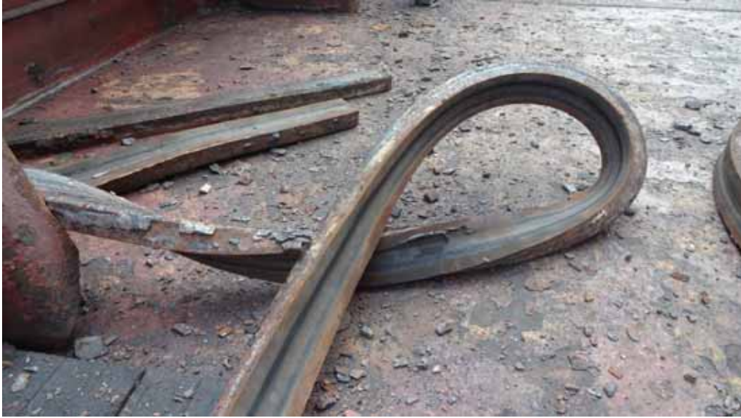
圖2.1 | 有著過多永久性溝紋的橡膠密封件應當換新。
