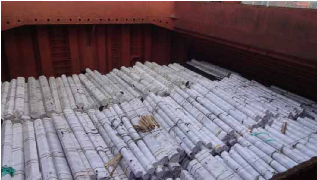
圖3.10 | 包裝好的小直徑鋼管呈艙艙向積載。
