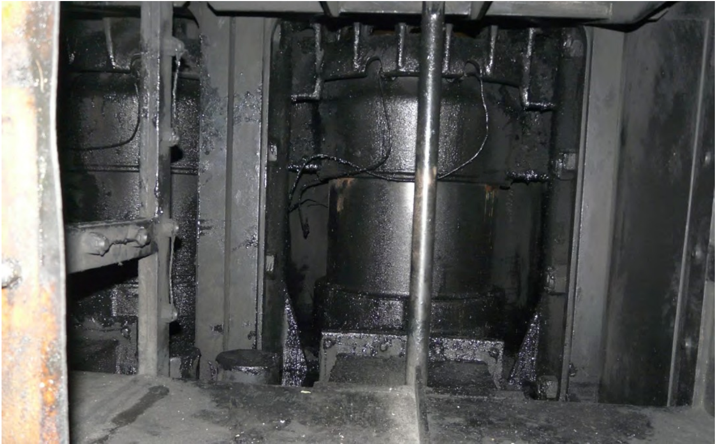
图 2.4 | 扫气箱在着火后出现积碳
