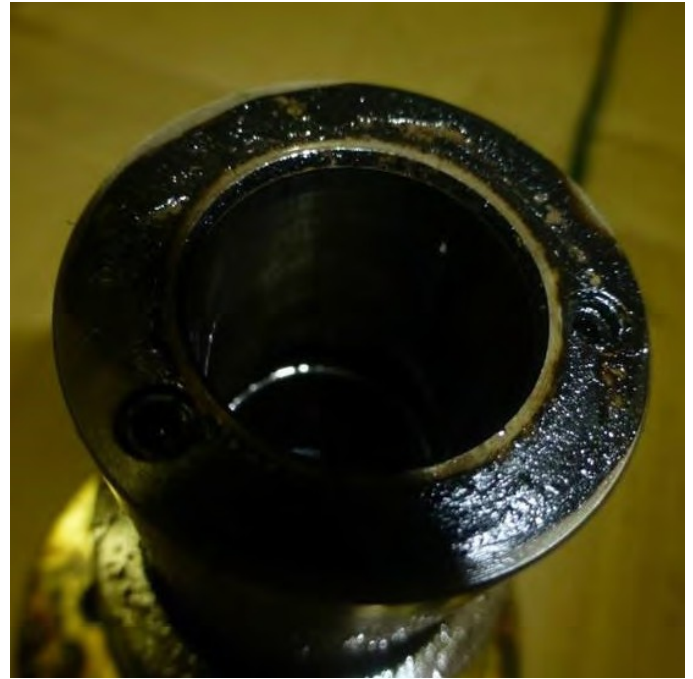
圖2.3 | 燃油泵管處有大量受污染燃料殘渣積聚
