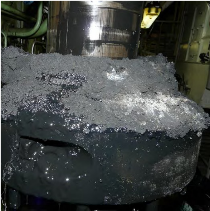
圖 2.5 | 主發動機填料箱積碳
