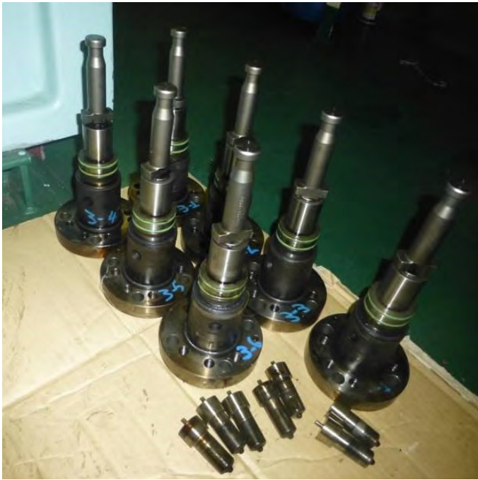
圖2.2 | 準備更換受損部件的全新清潔燃料泵柱塞和噴嘴
