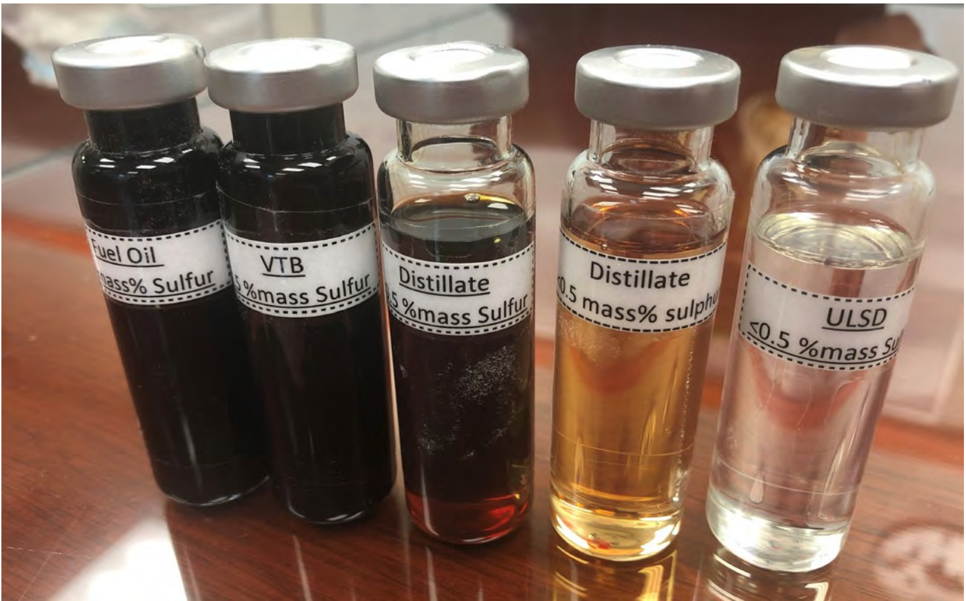
圖4.1 | 硫含量<0.5%的多種樣本，包括船用燃油、真空塔底油(VTB)、兩種餾出物以及超低硫含量餾出物
