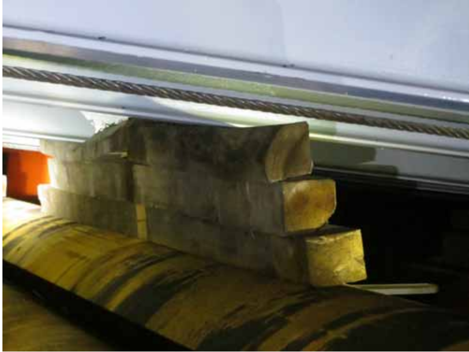
图4.9 | 圆形货物上方放置的垫舱物排布不当。
