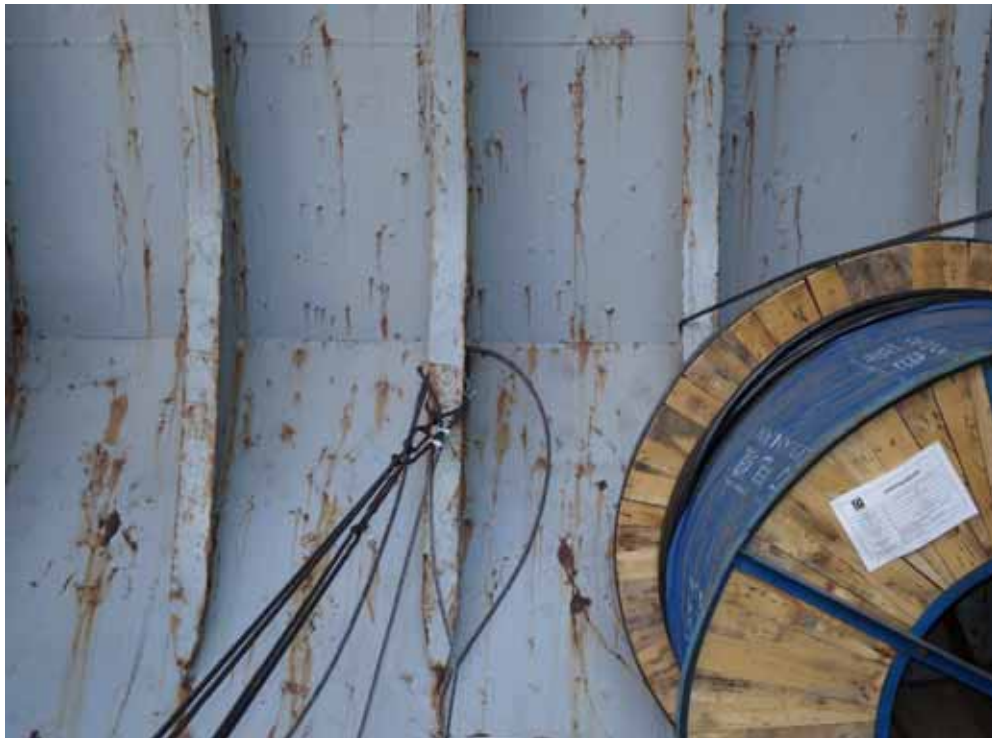
图5.33 | 应避免如图所示，将绑扎物绑缚于舷边肋骨上。
