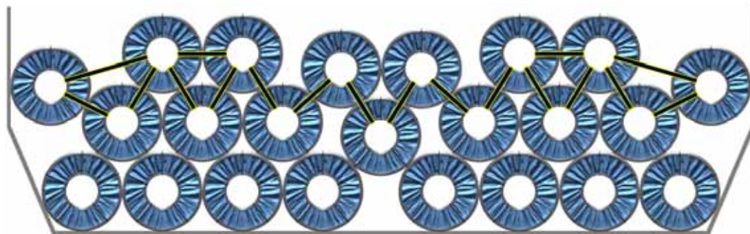
图5.12 | 完整三层钢卷的积载。请注意，底层无系固/绑扎，只有顶层被系固于紧挨着的下一层钢卷上。
