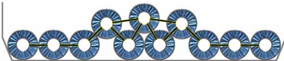
图5.11 | 局部两层钢卷的积载，其中两个锁定钢卷对称放置。请注意，考虑到第二层钢卷之间的较大空隙，顶部中心钢卷被牢牢地系固/绑扎在四个相邻的钢卷上。
