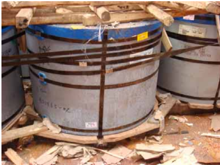
图5.21 | 使用货盘的钢卷以“卷眼朝上”的方式积载。
