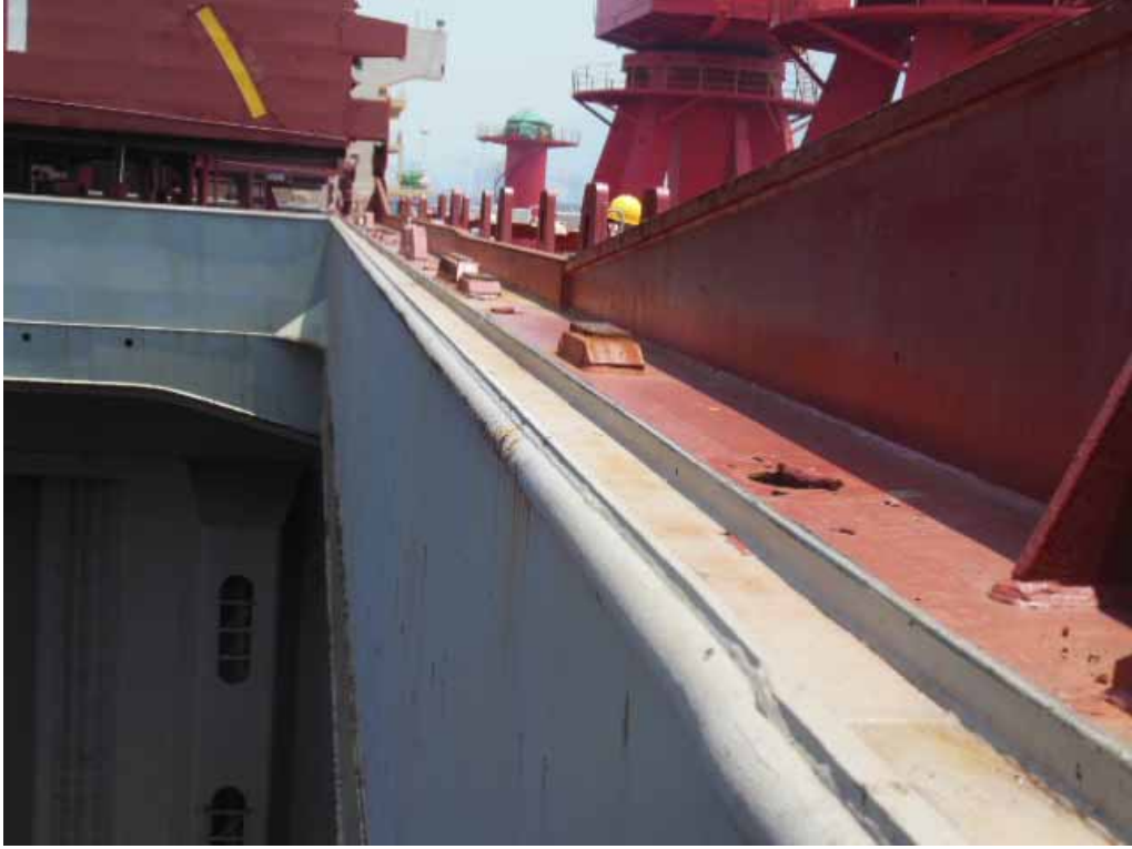
图2.2 | 表明处于良好状况的排水槽、压条和缓冲垫。
