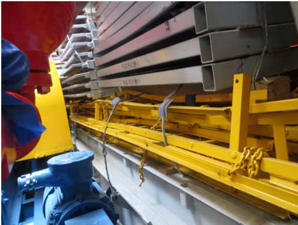
图1.15 | 由于积载和垫舱不当，造成钢质货物受损。
