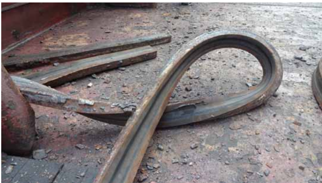
图2.1 | 有着过多永久性沟纹的橡胶密封件应当换新。
