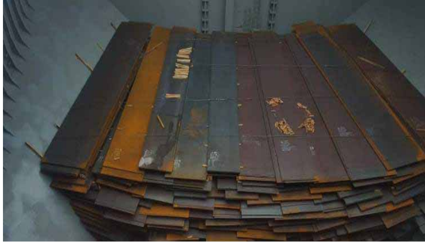
图5.24 | 细长钢板在艙部货舱内积载，并以钢丝绑扎。请注意，货物在斜边舱内的装载方式为：通过在斜边舱内层叠积载，充分利用待装货物的体积。
