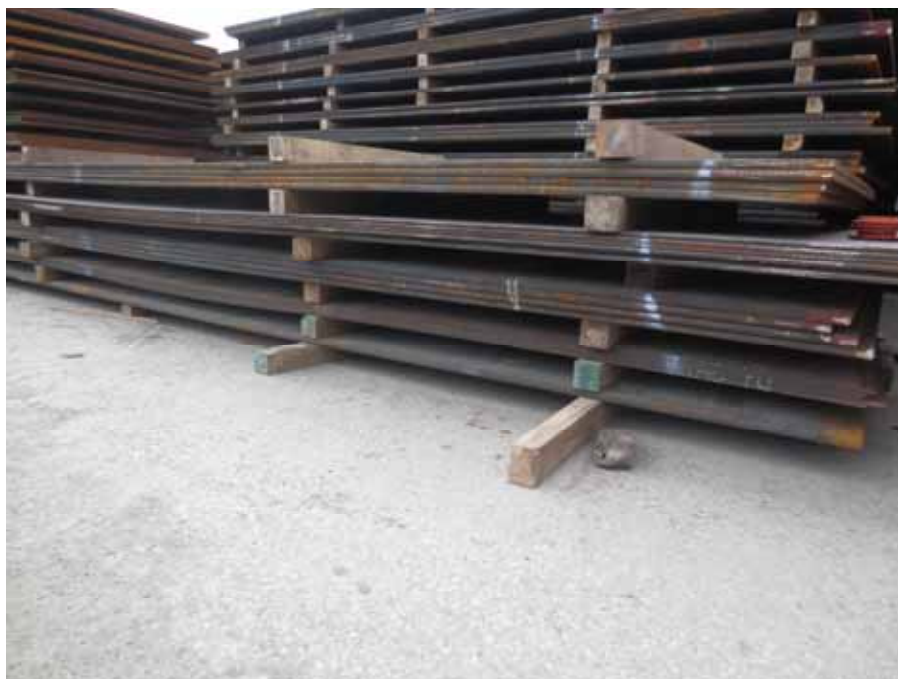
图4.3 | 岸上等待装船的钢板。请注意，衬垫物已适当地垂直排列，以免堆码钢板发生变形。对于在船上垂直堆码的单件和捆装钢板，此积载法同样适用。
