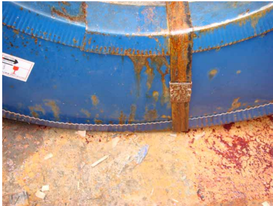
图1.3 | 因航程中货物汗湿而导致钢卷包装受损。
