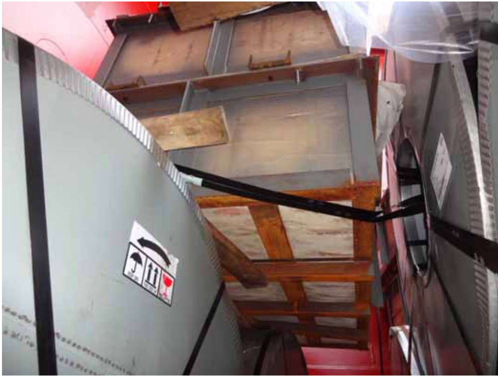
图5.6 | 请注意，木箱不应被搁在钢卷的系固钢带上。
