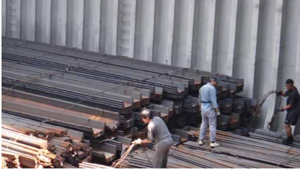
图5.30 | 装卸工人正准备对前景中的钢棒及钢板桩进行绑扎。背景中的槽钢已使用钢丝绳、绳夹和螺旋扣绑扎。
