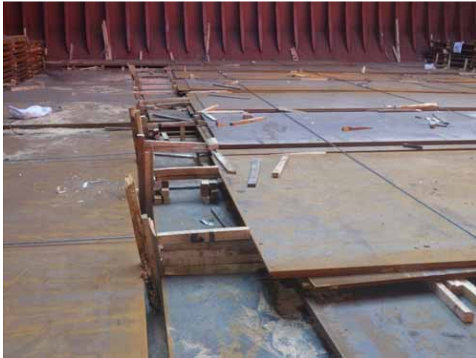
图5.27 | 船舶启航前，钢板之间的空隙应当适当垫塞。
