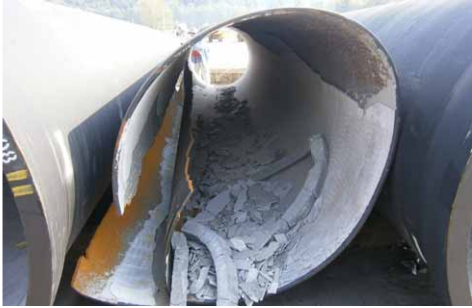
图1.8 | 受船上其他货物挤压而压坏的铸铁管。
