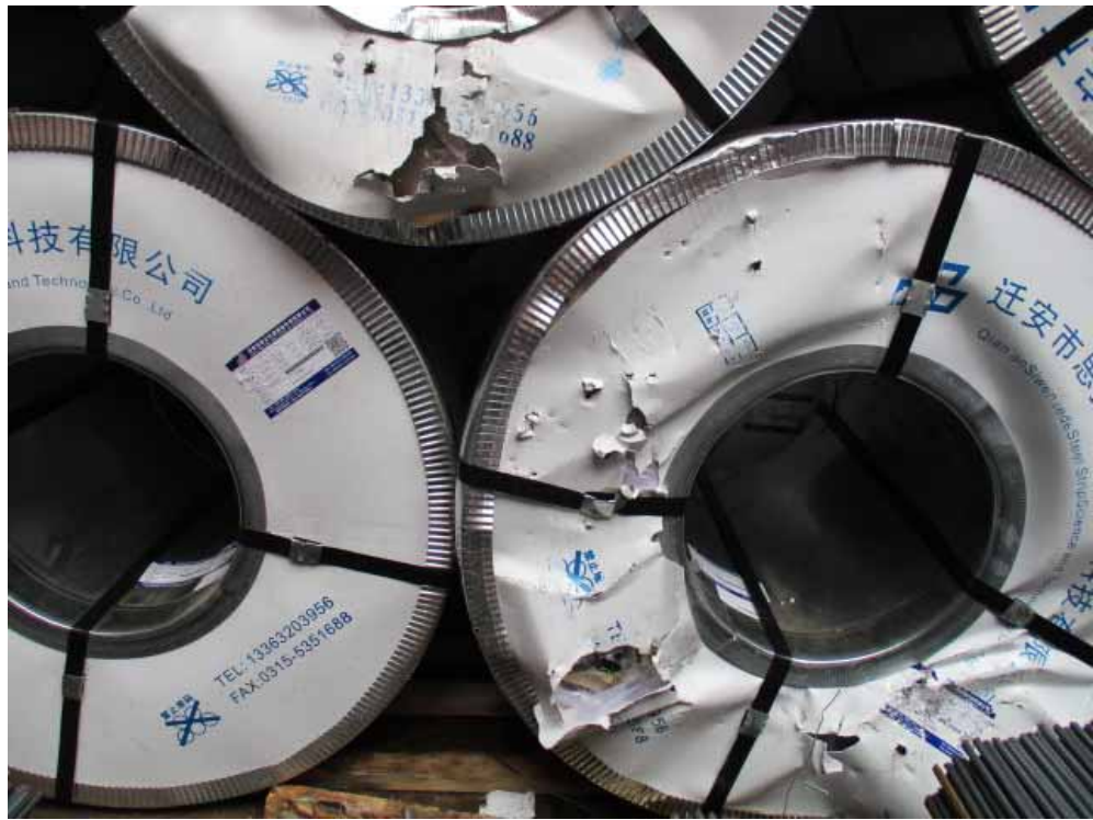
图1.13 | 因装卸工人粗暴搬运而受损的钢卷。
