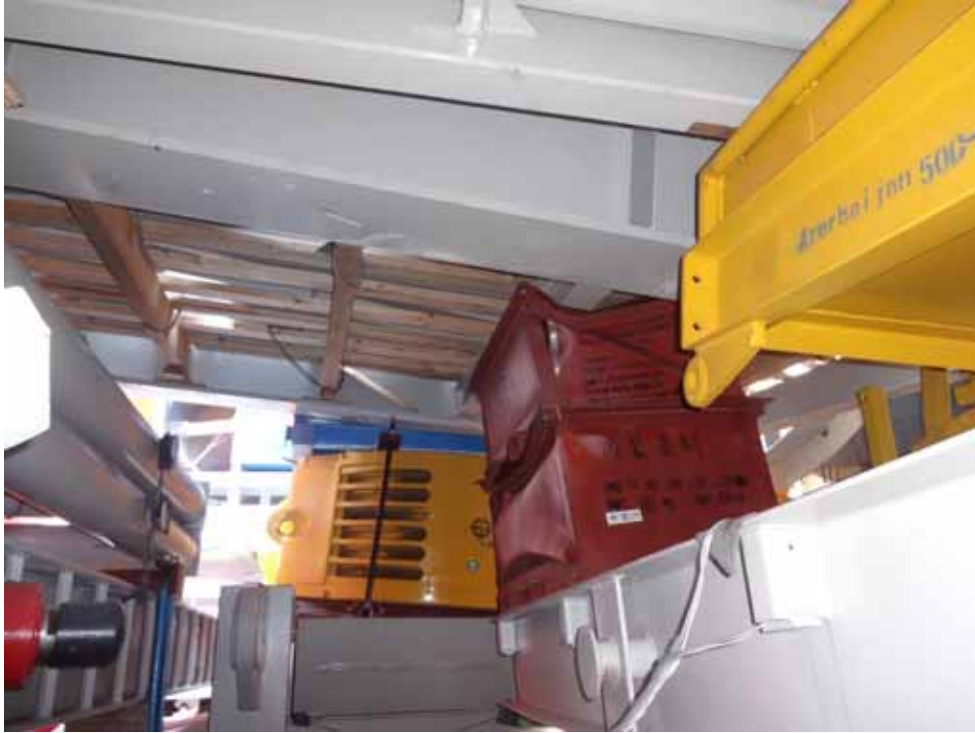
图1.14 | 在钢质箱体上方积载重货，导致堆码损坏及钢箱货物受损。
