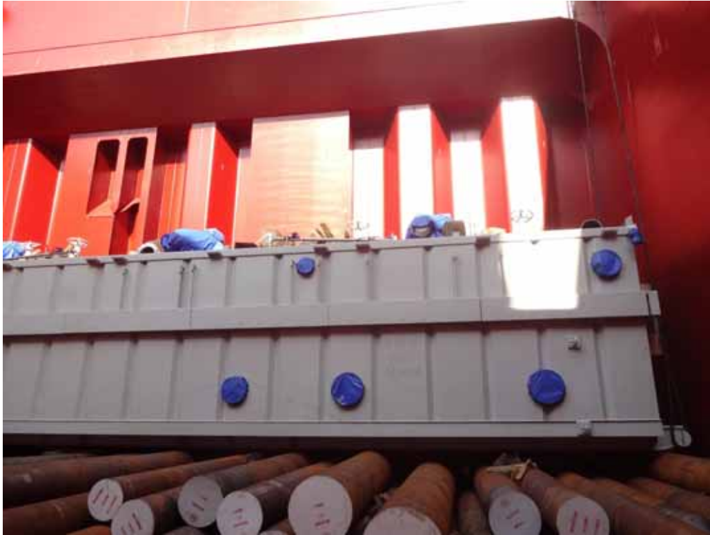
图4.11 | 在无适当衬垫物的情况下，将货物放置于圆形货物之上。
