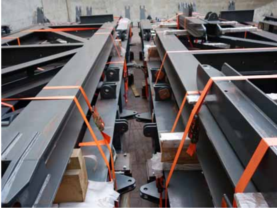
图5.32 | 用于“工”型梁的尼龙捆扎带和棘轮紧线器
