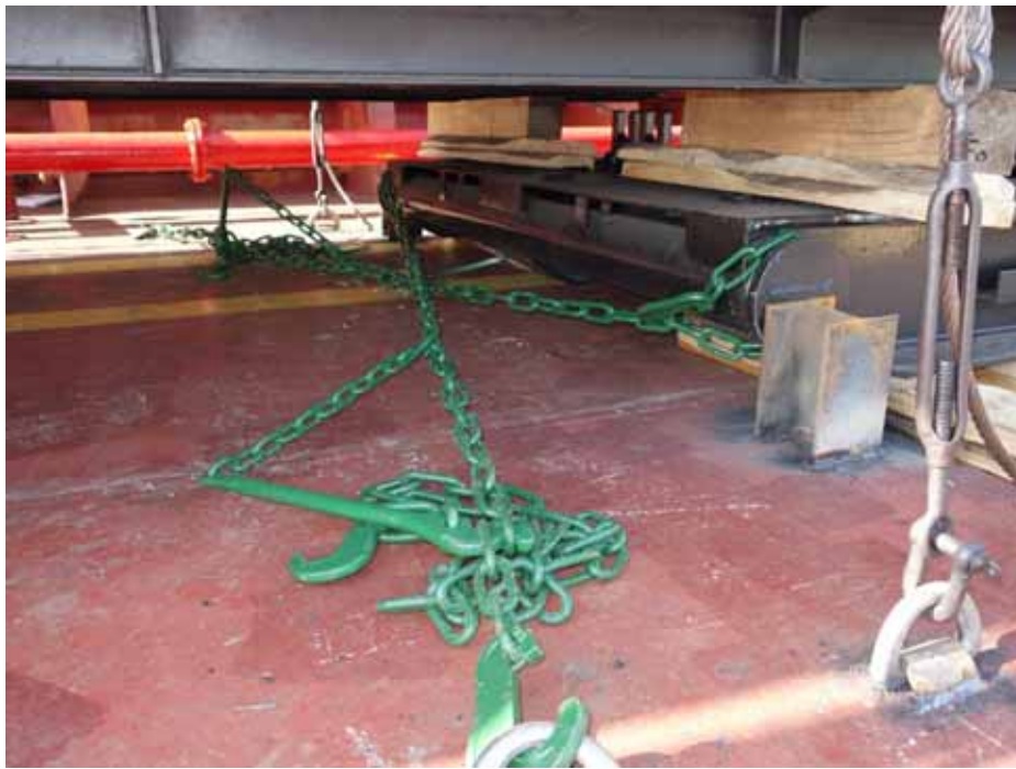
图5.31 | 用于系固钢质货物的钢链和止动扣。
