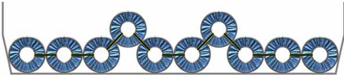
图5.7 | 单层钢卷的积载，其中有两个对称放置的锁定钢卷。
