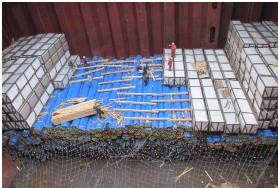
图3.9 | 货舱内混装的钢筋、小直径钢卷和其他钢制品。
