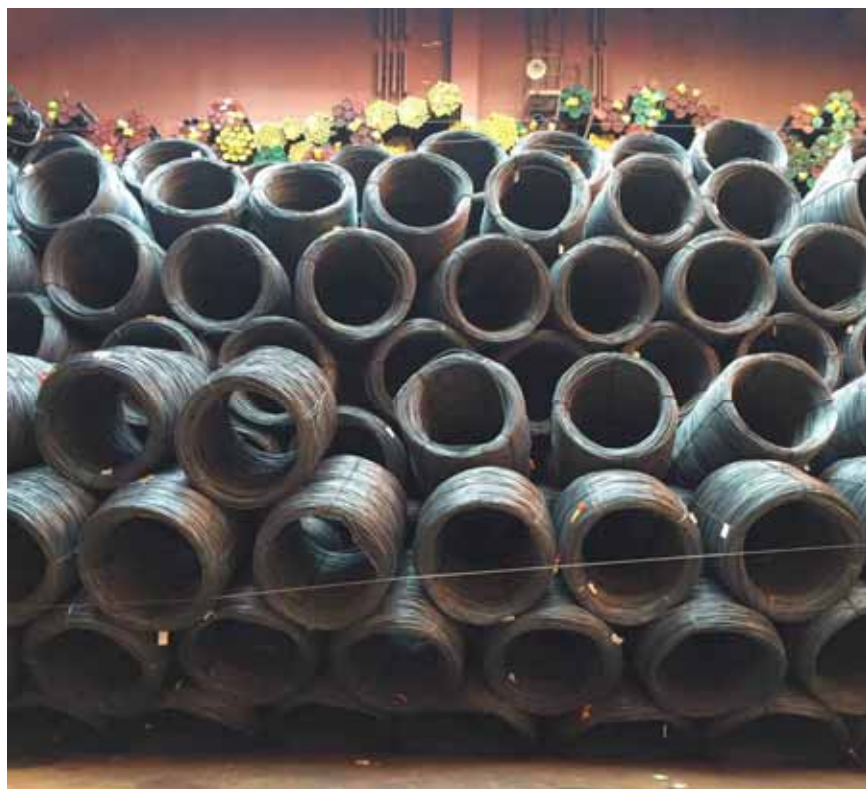
图1.16 | 由于积载和绑扎不当，导致盘条堆码坍塌。
