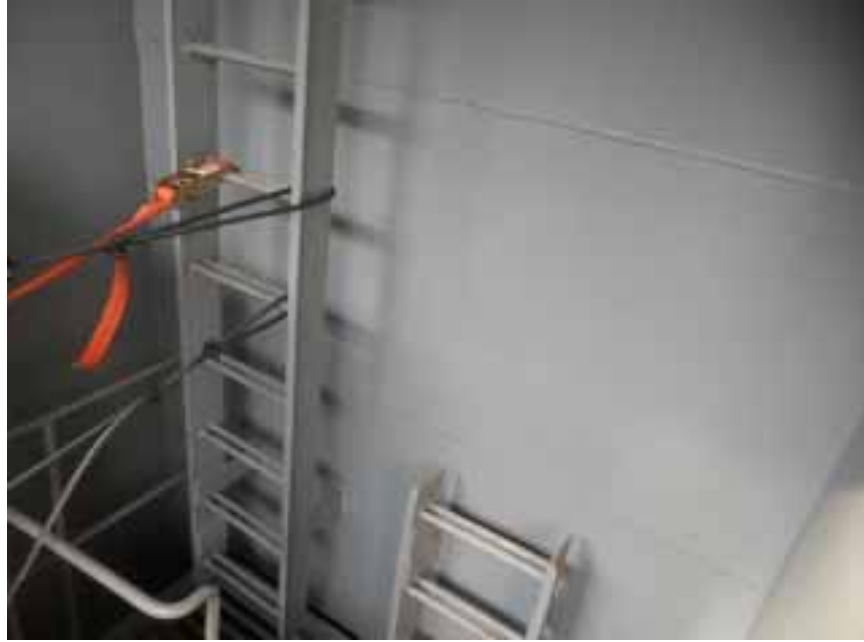
图5.34 | 应避免如图所示，将绑扎物绑缚于包括梯子在内的船舶结构上。
