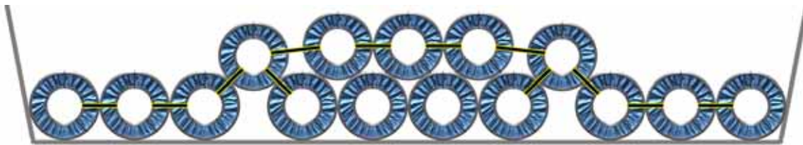
图5.10 | 局部两层钢卷的积载，其中两个锁定钢卷对称放置，第二层的部分钢卷以“覆盖”方式绑扎于第一层的两个中心钢卷的上方。
