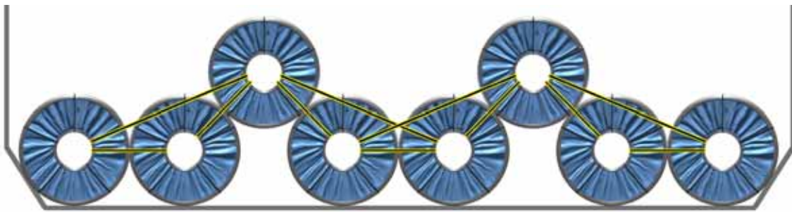
图5.17 | 单层重或超重钢卷的积载，其中两个锁定钢卷对称放置。请注意，与图5.7相比，超重钢卷中的“关键”或“锁定”钢卷有额外系固/绑扎。
