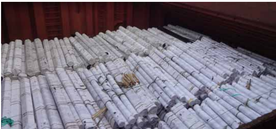
图3.10 | 包装好的小直径钢管呈艏艉向积载。
