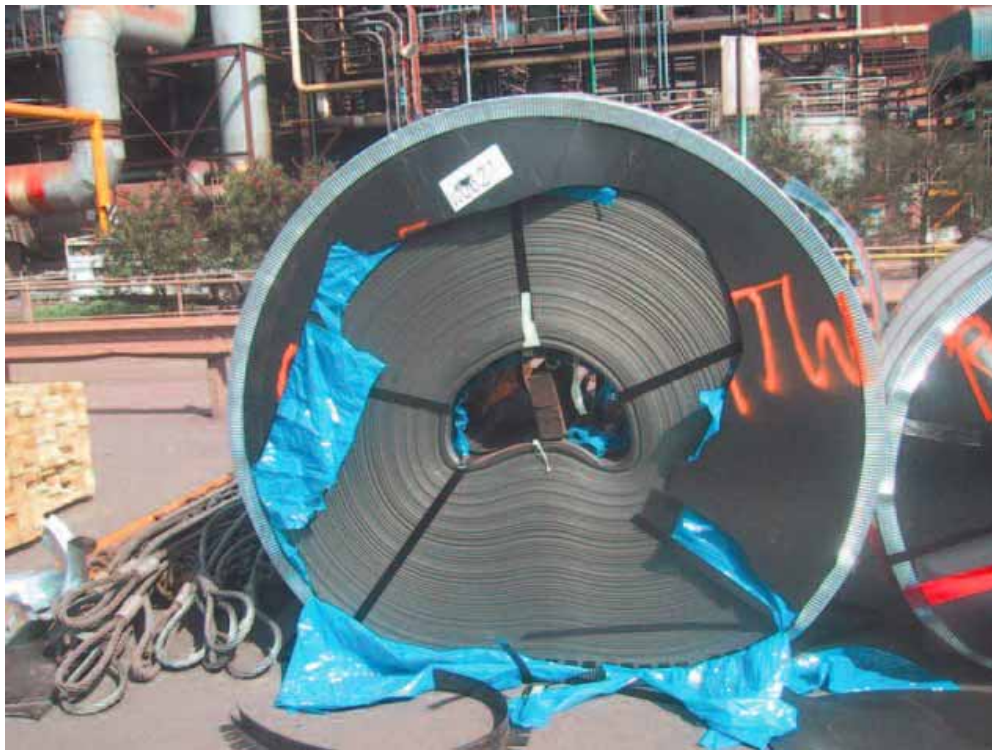
图1.11 | 因顶层装载重量过大而变形的冷轧钢卷。
