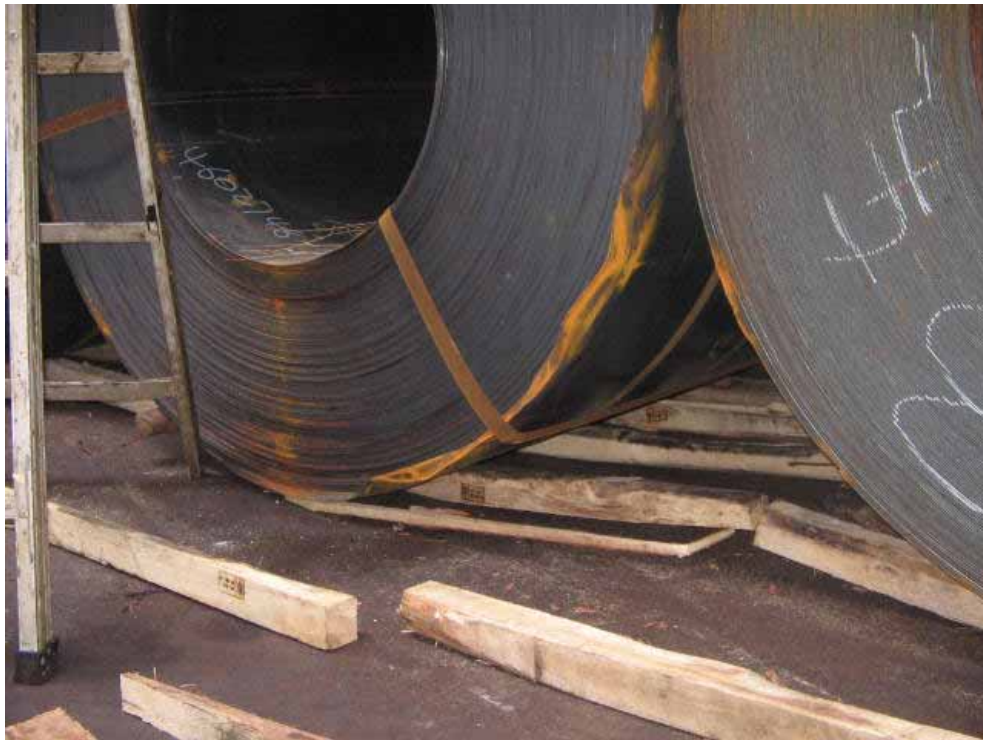
图4.12 | 垫舱木料被钢卷的重量压弯和压碎。
