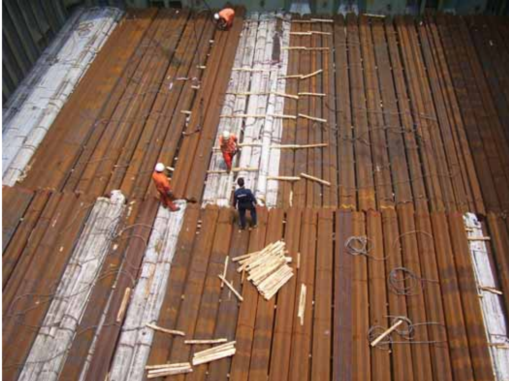
图3.12 | 角钢和钢管在货舱内呈艏艉向积载。
