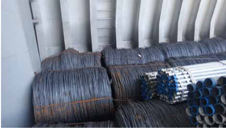
图1.2 | 积载的钢丝和小直径钢管。请注意，后排最左的钢卷由于压靠在舷侧肋骨上而发生了变形。对于较高的钢卷货堆，这一点尤其值得注意，因为低层钢卷会有被压向船舶外部舱壁的情况。
