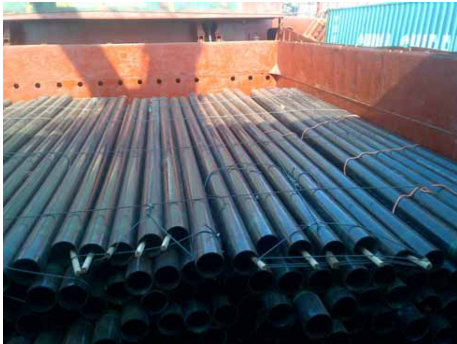
图5.35 | 经系固/绑扎的大直径钢管。请注意，前景中插入钢管内的垫木是用来绑扎和系固积载于顶层的钢管的。
