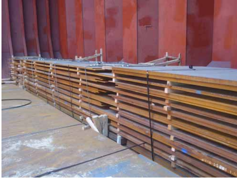
图5.28 | 靠着舱壁横向堆码的钢板经适当衬垫，并使用钢质绑扎带绑扎/系固。
