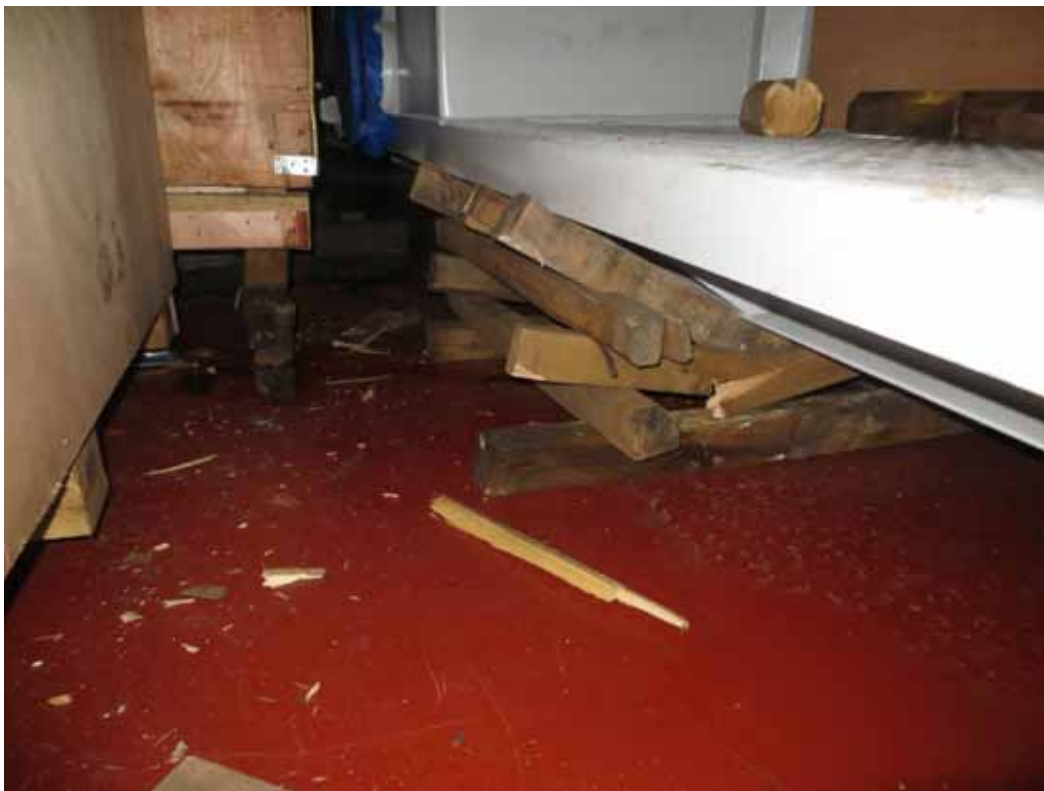
图4.7 | 垫舱物被压坏，导致堆码货物受损。
