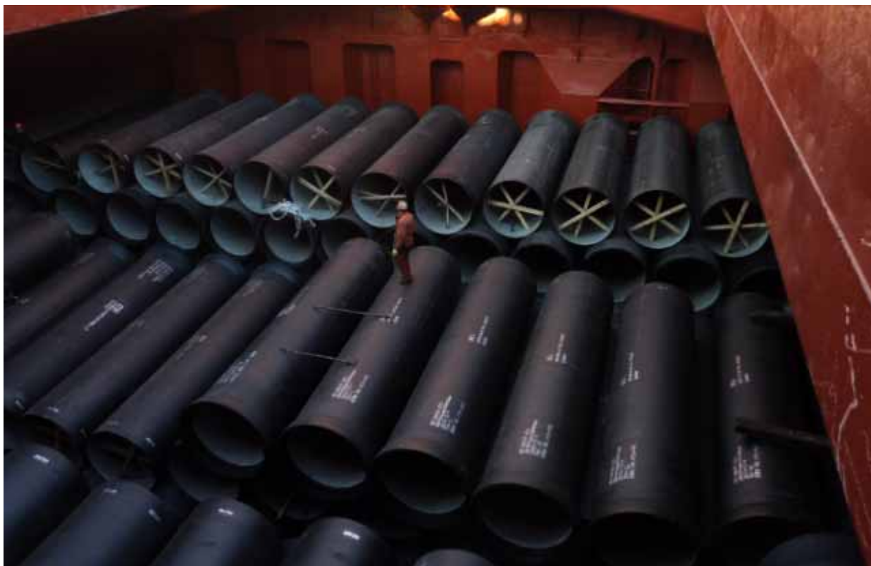
图3.3 | 带型锻管端的大直径钢管呈船艙向积载。请注意钢管的积载方式为：各层反向放置，以确保相邻两层的型锻管端不叠放。
