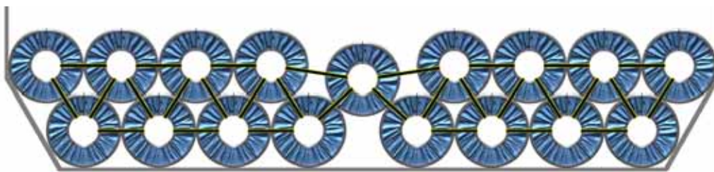
图5.8 | 两层钢卷的积载，其中第二层钢卷排布至舷侧外板。
