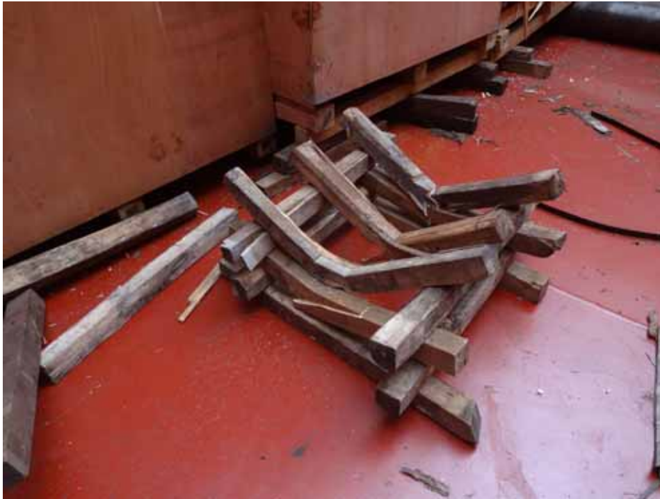
图4.10 | 排布不当的垫舱物在货物重压下坍塌。
