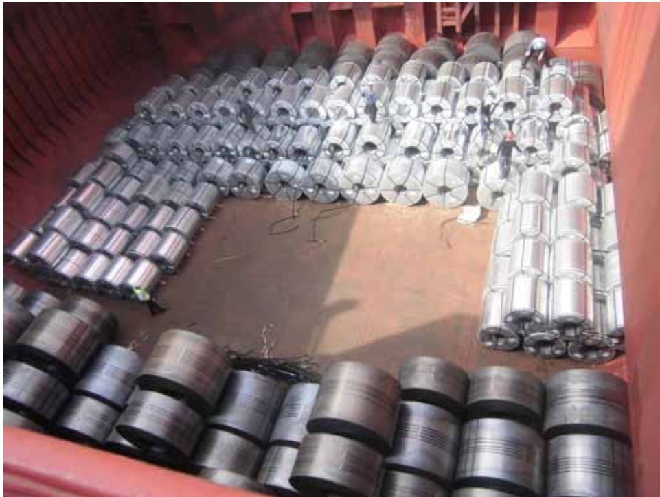
图3.6 | 积载于货舱内的冷轧钢卷使用1英寸 ( 2.5厘米 ) 扁平钢带绑扎。
