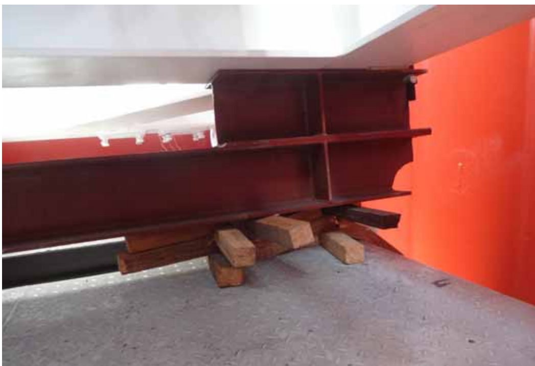
图4.8 | 由于排布不当，造成垫舱物被压坏。
