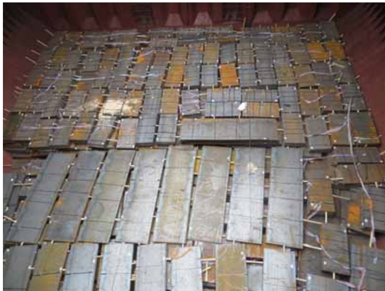
图5.25 | 货舱内积载和绑扎的成捆钢板。请注意位于照片前景中的长钢板的垫木，垫木之间有着适当的水平间距，以防钢板在运输途中发生变形。
