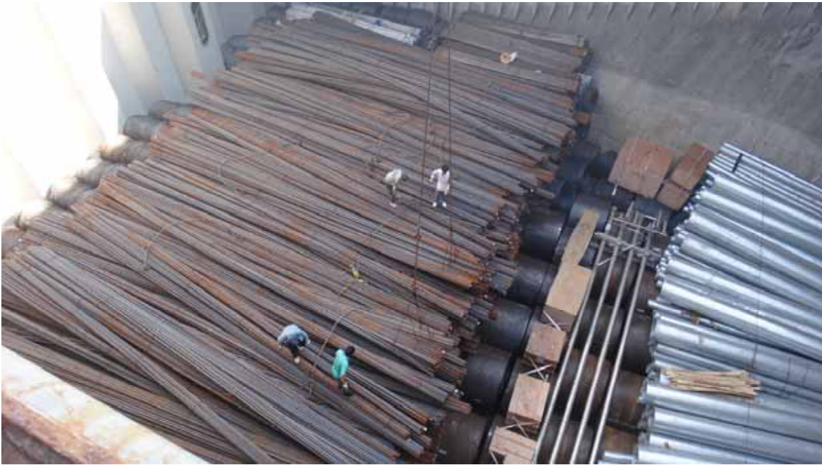
图3.2 | 装卸工人正在积载、系固和绑扎钢质货物组合。
