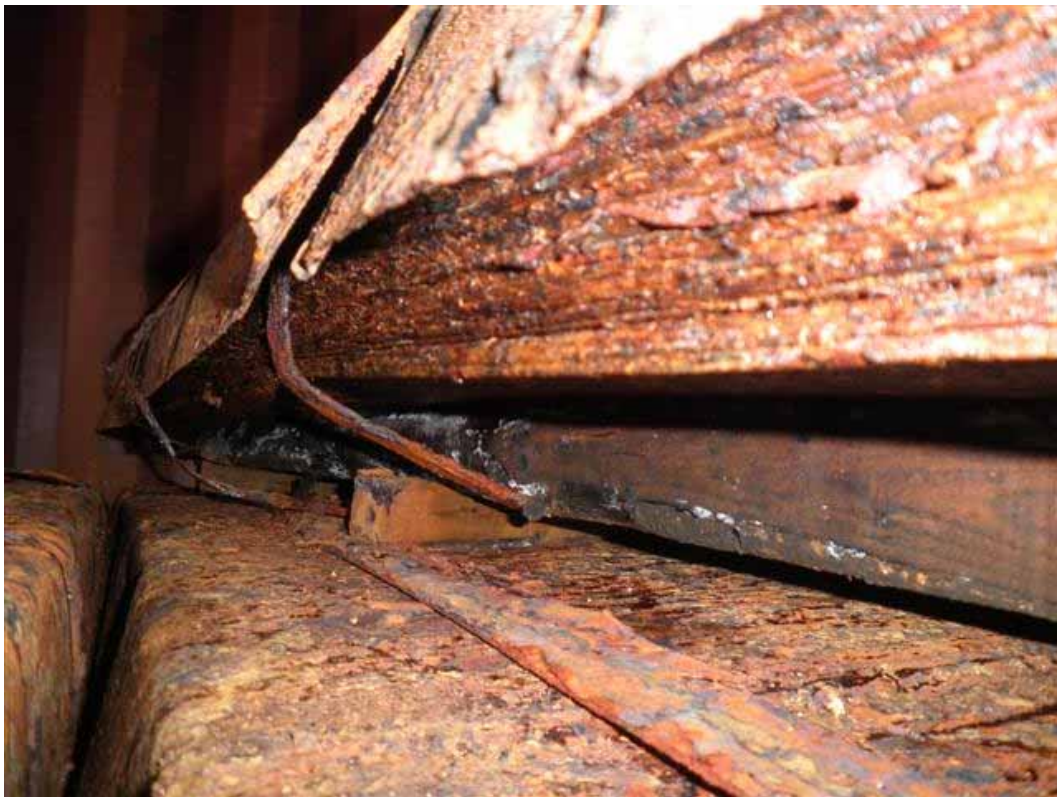
图1.7 | 严重生锈的钢锭。
