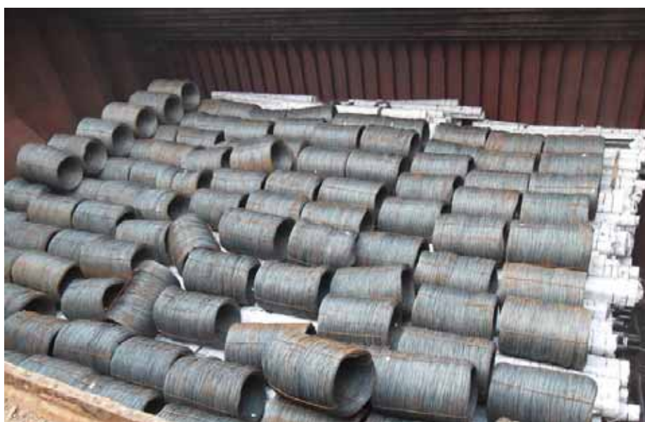
图4.2 | 堆垛于包装钢管上方的单层和双层钢盘条。
