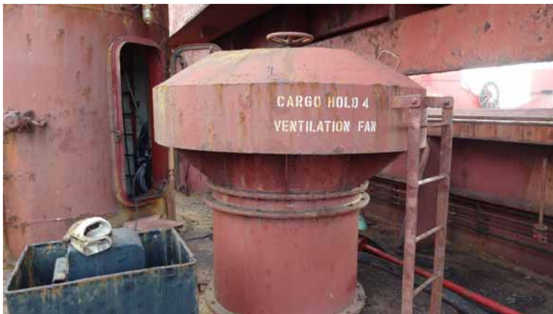
图2.6 | 货舱的机械通风装置。
