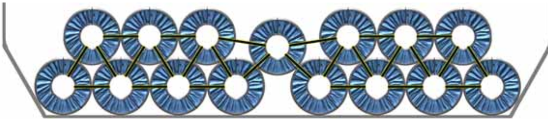
图5.9 | 两层钢卷的积载，其中第二层钢卷按两个半金字塔形装载。请注意，与图5.8相比，第二层的外侧钢卷有额外绑扎/系固，以防这些钢卷在运输途中向舷侧外板移动。
