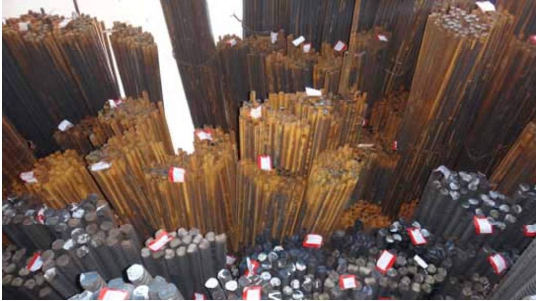
图1.6 | 船上积载的钢筋，顶层为捆装货，因船舶运输途中水从舱盖进入而在卸货港出现锈蚀。
