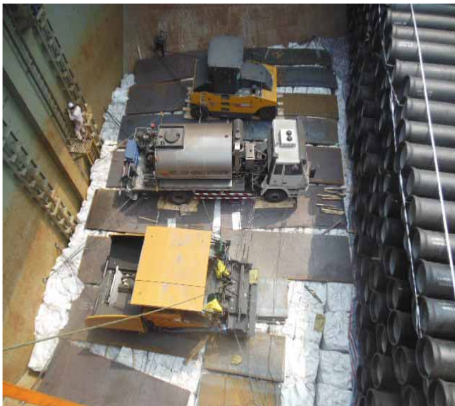
图3.13 | 将钢板置于袋装货物上方，以支撑车辆和机器，相邻的大直径钢管呈船艏向装载。
