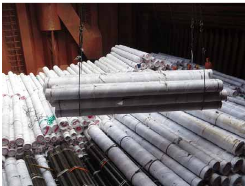
图3.4 | 包装好的成捆大直径钢管正在被装入货舱。
