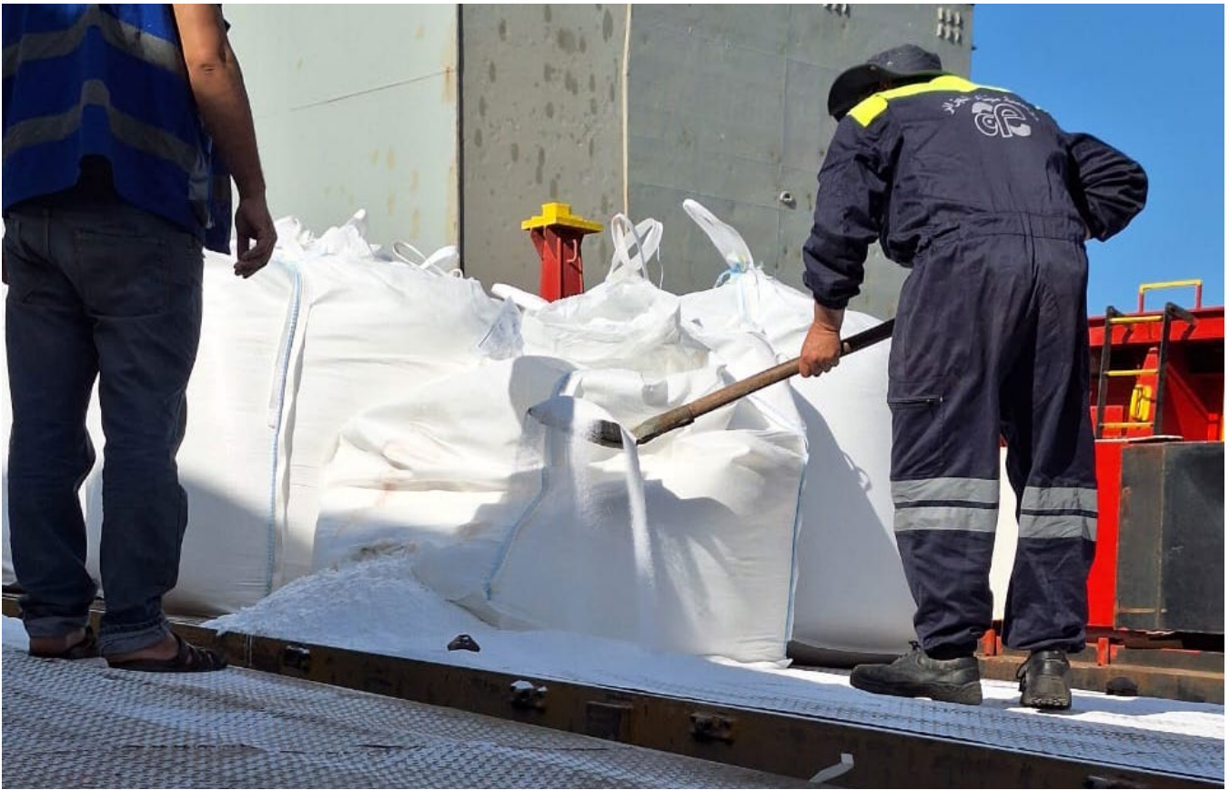
圖 2 | 船舶甲板上自破损聚丙烯袋中铲出并重新装袋的货物（由Budd Algiers提供）
