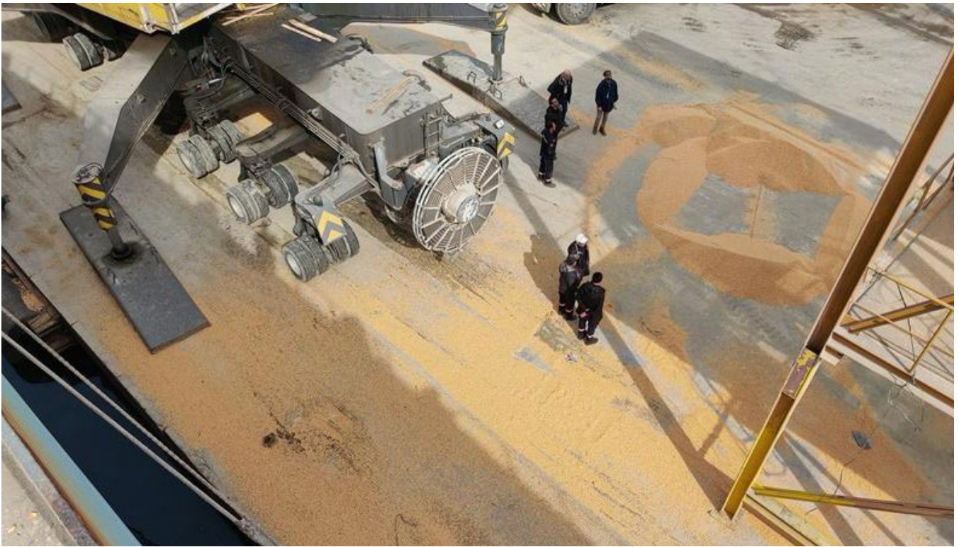
圖 7 | 船舶卸货期间散装谷物货物散落码头岸线 (图片来源: Budd Algiers)
