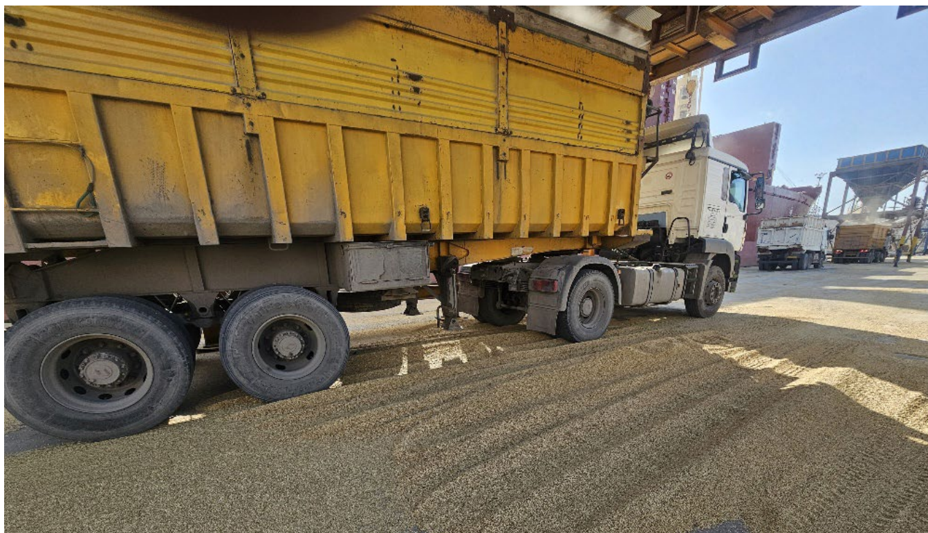
圖13 | 在裝載機轉移到卡車上時，大量散裝貨物可能會丟失（圖源來自Budd Algiers）
