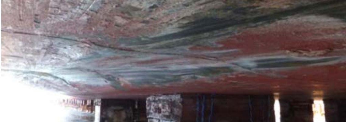
因搁浅对螺旋桨和船体底部造成损坏
