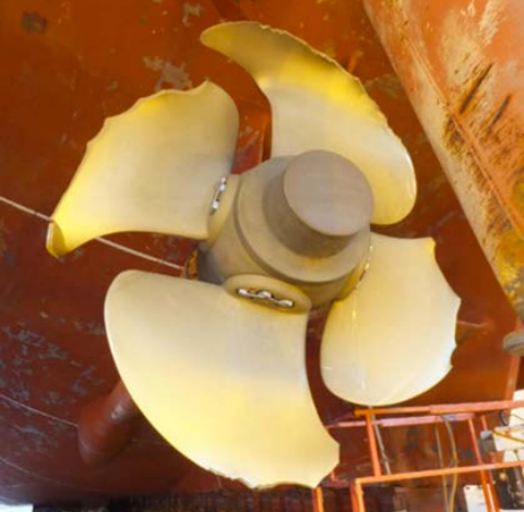
因搁浅对螺旋桨和船体底部造成损坏
