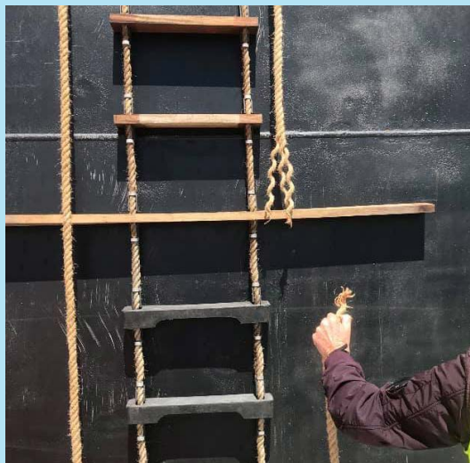
引水梯踏板处的侧绳磨损和断裂。
