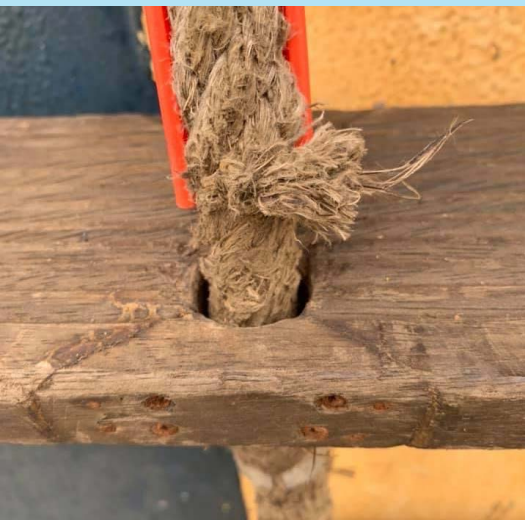
引水梯踏板处的侧绳磨损和断裂。
