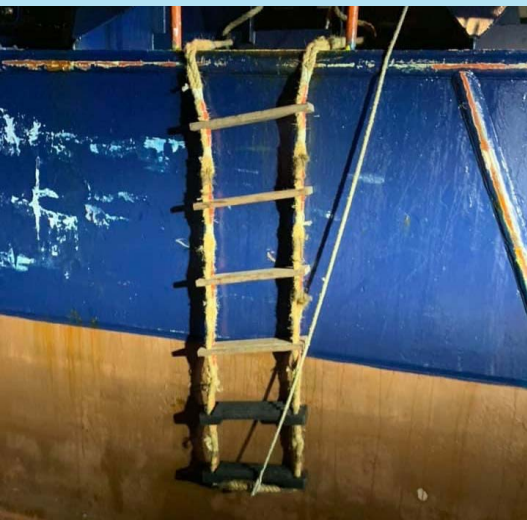
这个梯子不是引水梯，因为它没有铺板和四个橡胶踏板。回收索挡住了踏板。
