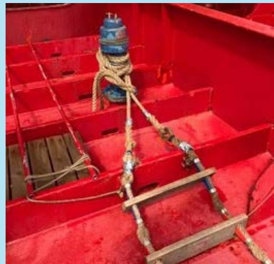
引水梯不应当被安装在如此处所示的非指定的固定点上。
