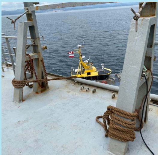
引水梯不应当被安装在如此处所示的非指定的固定点上。
