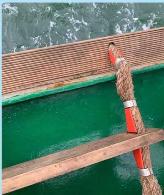
如果没有对尖锐边缘做好防护，那么引水梯绳的磨损速度会更快。
