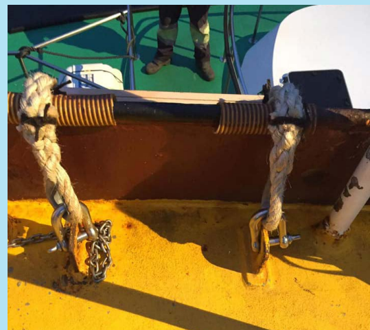
設計良好的引水點裝有一段切割好的鋼管，以確保引水梯能越過光滑的邊緣。
