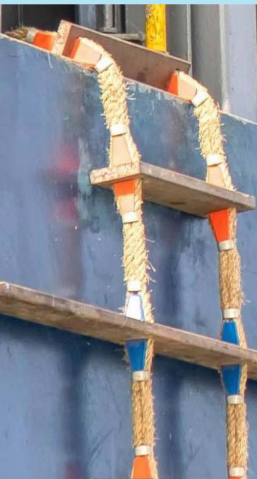
引水梯越過的地方存在尖銳邊緣。
