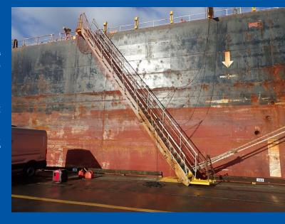
後來經測量,舷梯的傾斜角度為60度。舷梯的製造商表示,最大的傾斜角度應該是55度,並且舷梯 側面的標籤也標示了這個最大角度。
