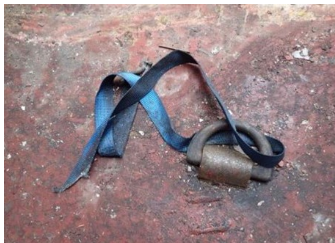
货物固定带断裂。
