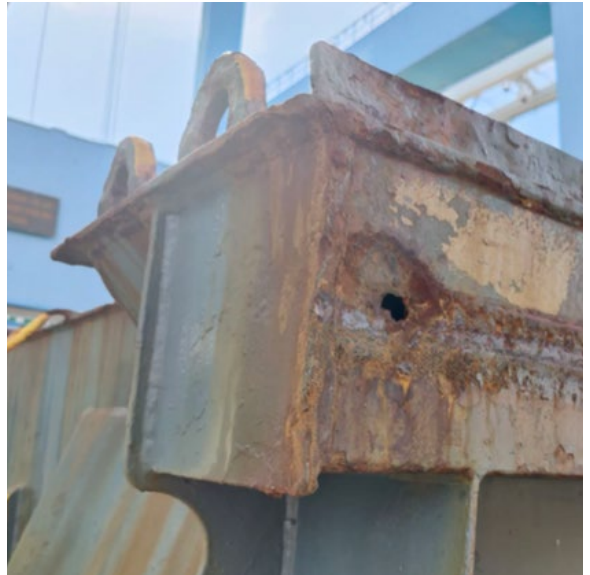
舱口盖上的一个洞，恶劣天气下，水会通过这个洞流入货舱。
