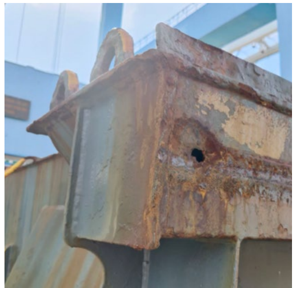
艙口蓋上的一個洞，惡劣天氣下，水會通過這個洞流入貨艙。
